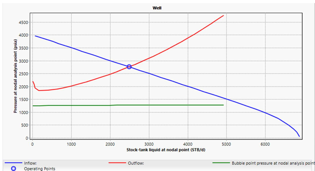
Εικόνα 33 Ανάλυση κόμβου του λογισμικού Pipesim
