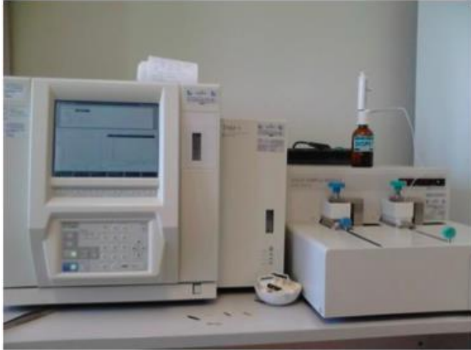
Εικόνα 10: Συσκευή μέτρησης TOC.
