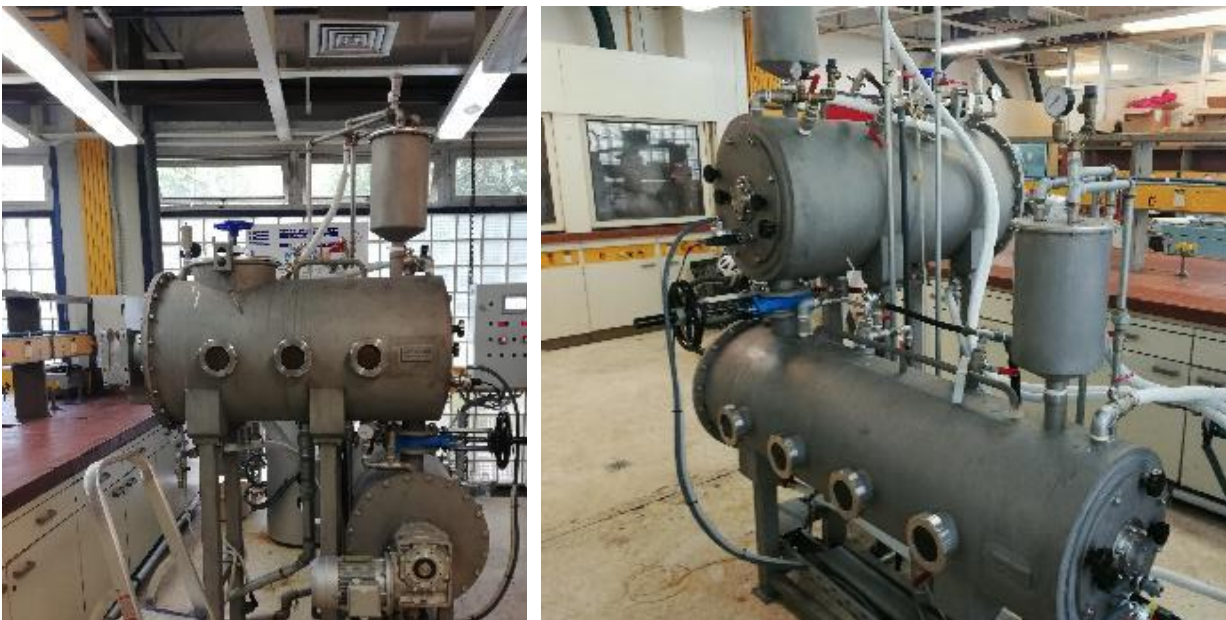
Εικόνα 15: Οι δύο βιοαντιδραστήρες της πιλοτικής μονάδας.
