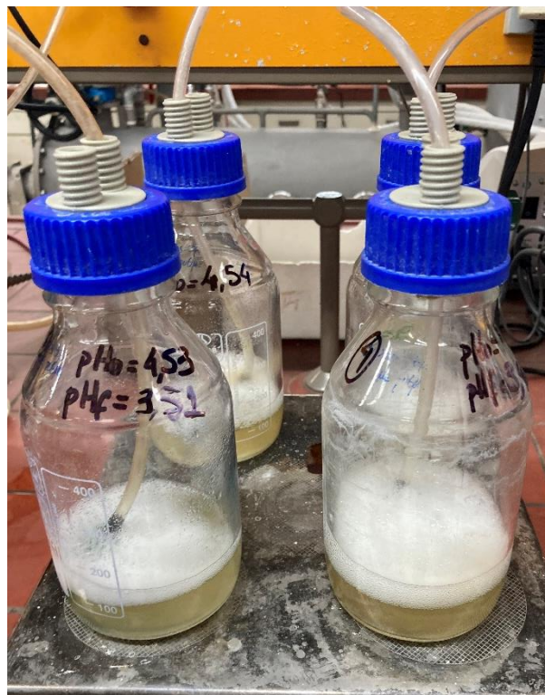
Εικόνα 13: Πειραματική διάταξη αερόβιας ζύμωσης.
