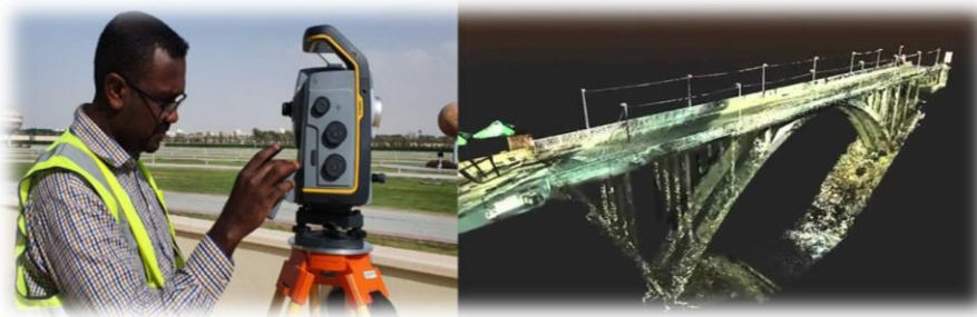
Εικόνα 2.19 Μέθοδος LiDAR: επίγειος εξοπλισμός αριστερά και 3D μοντέλο γέφυρας δεξιά (Abu Dabous & Feroz 2020).
