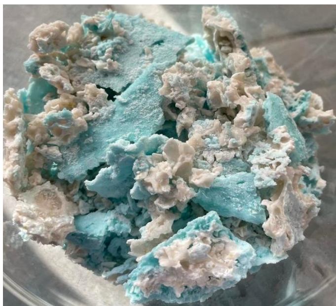
Εικόνα 4: Δείγμα μετά την αποδέσμευσή του από το καλούπι αλουμίνας
