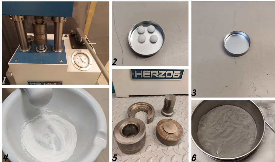
Εικόνα 4.6: Εξοπλισμός και αναλώσιμα. 1. Υδραυλική πρέσα 2.Κυτταρίνη 3. Κυάθιο 4. Δοχείο και αναδευτήρας από πορσελάνη 5. Καλούπια και δακτύλιος της πρέσας 6. Μεταλλικό κόσκινο κοκκομετρίας 45μμ
