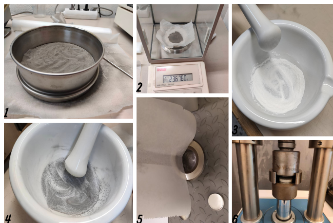
Εικόνα 4.7: Στάδια παρασκευής των Pellets. 1. Αφαίρεση ανεπιθύμητων κόκκων από το υλικό 2. Ζύγισμα του υλικού 3. Διάλυση της κυτταρίνης 4.Ομογενοποίηση του μείγματος 5. Τοποθέτηση του μείγματος υλικού-binder στο καλούπι 6. Συμπίεση του δείγματος
