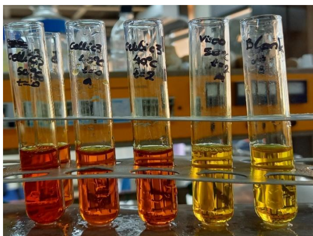
Εικόνα 13. Ο υπολογισμός της ολικής ενεργότητας κυτταρινασών με τη μέθοδο 3,5-δινιτροσαλικυλικού οξέος (DNS).
