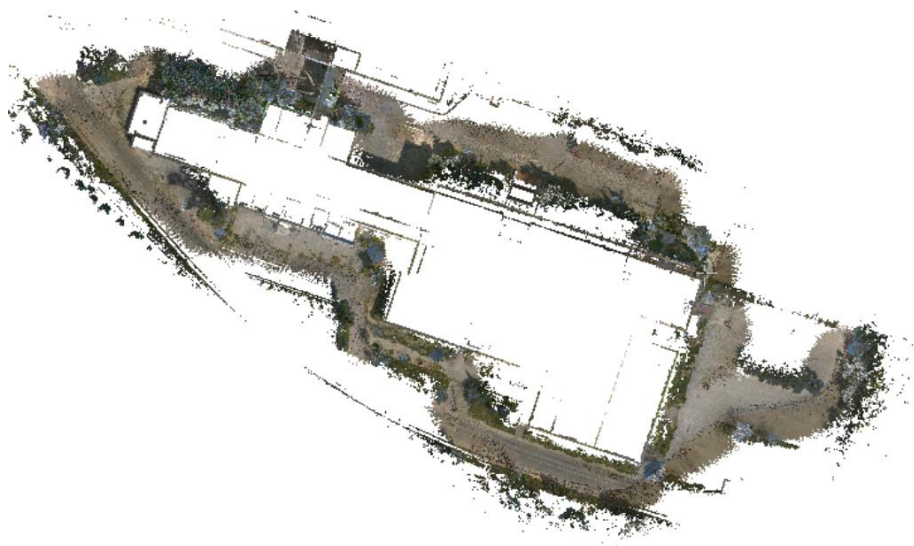
Εικόνα 7.14 – Νέφος σημείων BLK2GO με φίλτρο θορύβου (Κάτοψη)
