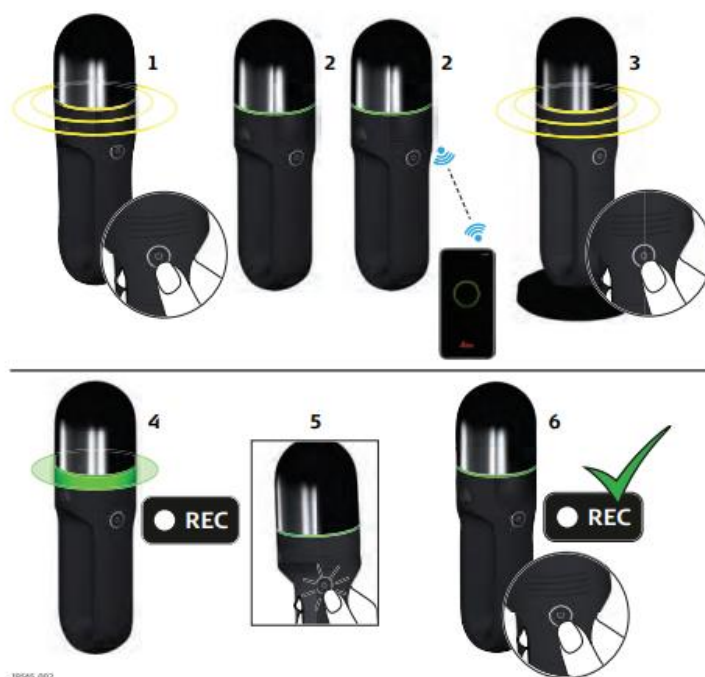
Εικόνα 4.5 – Φωτεινές ενδείξεις κατά τη σάρωση με το BLK2GO (Leica Geosystems, 2019)
