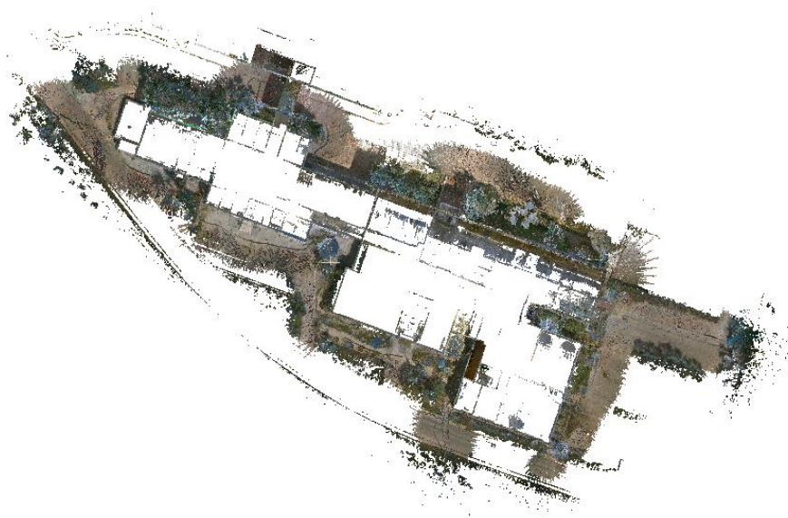
Εικόνα 7.42 – Νέφος σημείων BLK2GO με φίλτρο θορύβου (Κάτοψη)
