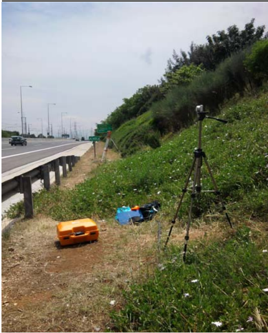
Εικόνα 4.2 Φωτογραφική μηχανή Φ1 και ολοκληρωμένος γεωδαιτικός σταθμός
