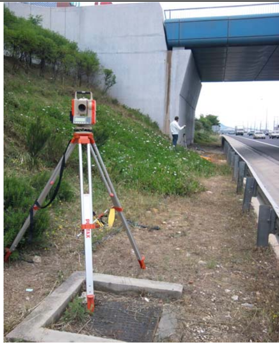
Εικόνα 4.3 Ολοκληρωμένος γεωδαιτικός σταθμός και φωτογραφική μηχανή Φ1
