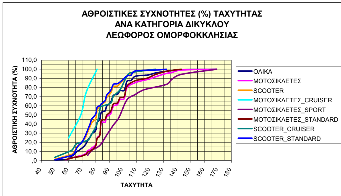
Σχήμα 6.4 Διάγραμμα αθροιστικών συχνοτήτων της ταχύτητας ανά κατηγορία δικύκλων και ανά κατηγορία στάσης οδήγησης για τη λεωφόρο Ομορφοκκλησίας
