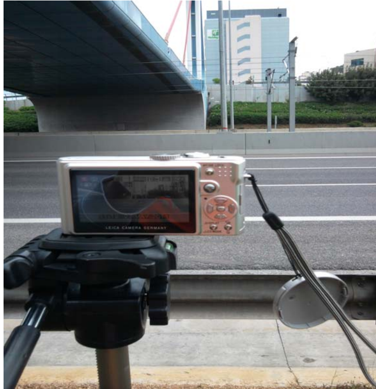
Εικόνα 4.5 Φωτογραφική μηχανή και χαρακτηριστική λωρίδα υλοποίησης οριζοντίου επιπέδου αναφοράς των μετρήσεων
