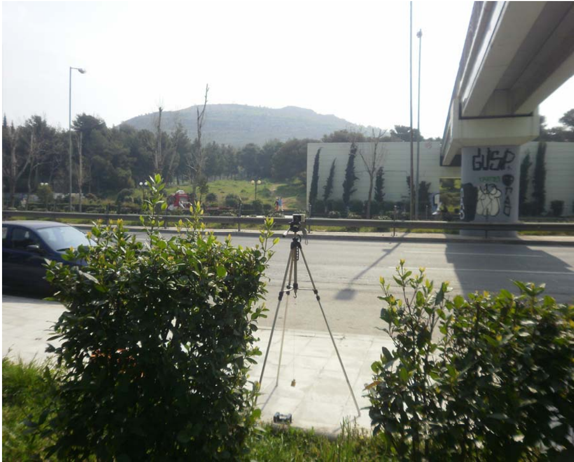
Εικόνα 4.15 Φωτογραφική μηχανή και χαρακτηριστική λωρίδα υλοποίησης οριζοντίου επιπέδου αναφοράς των μετρήσεων
