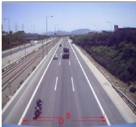
Εικόνα 5.3 Μέτρηση οριζοντίων αποστάσεων S και D στην Αττική Οδό
