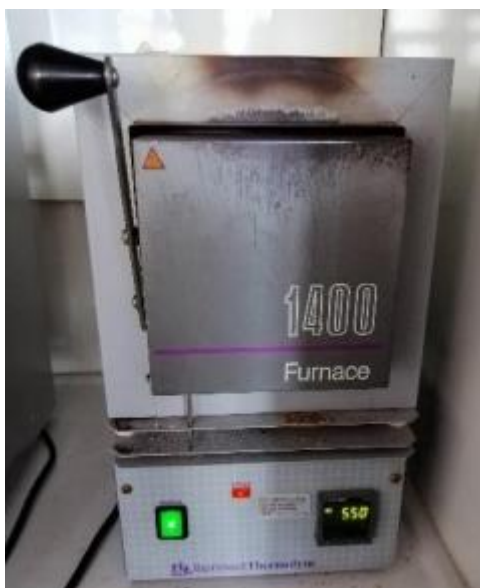
Σχήμα 6.4: Φούρνος Barnstead Thermolyne που χρησιμοποιείται για την μέτρηση των πτητικών στερεών.
