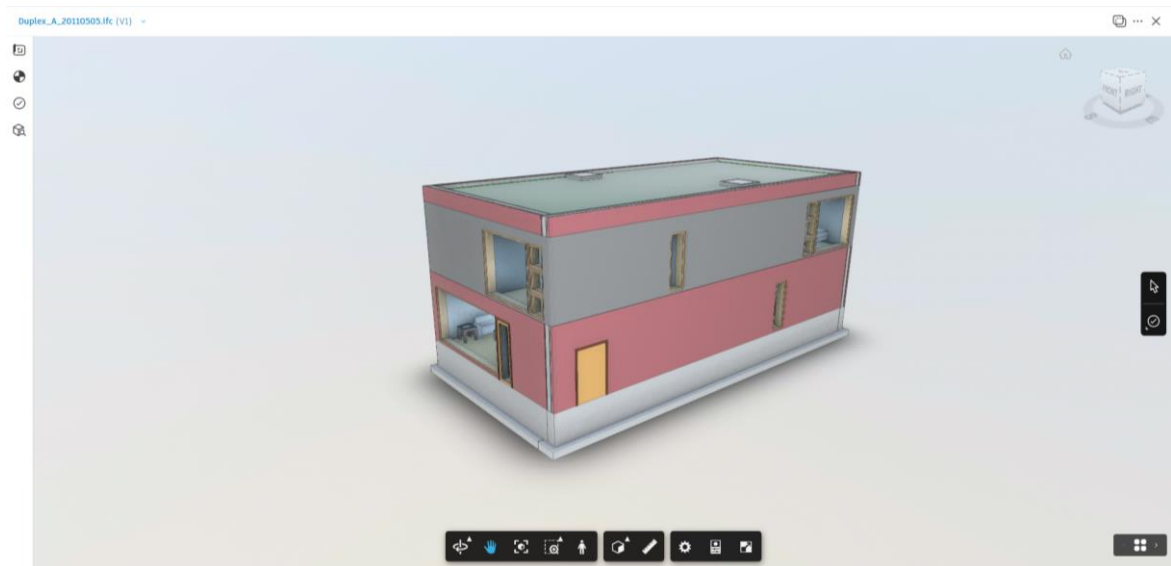
Εικ. 2.2: Προβολή και επεξεργασία IFC αρχείου σε περιβάλλον Autodesk Construction Cloud [02]
