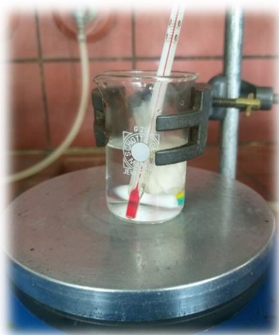
Εικόνα 12: Πειραματική διάταξη για την εφαρμογή της μεθόδου μεμβρανών διάλυσης-διάχυσης.
