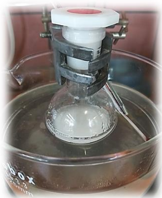
Εικόνα 5: Διαδικασία παρασκευής διαλύτη NaDES Βεταΐνη-D,L Γαλακτικό οξύ-Νερό 1:2:2.5.
