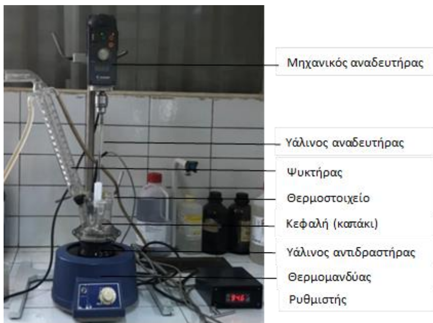
Εικόνα 5.4. Διάταξη του εκχυλιστήρα
