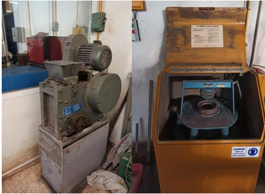
Εικόνα 5.2. Εργαστηριακός θραυστήρας σιαγόνων (αριστερά) και συσκευή Lab Technics LM2 Laboratory Pulverising Mill (δεξιά)
