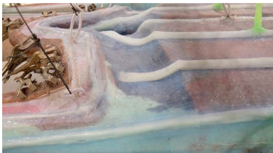
Σχήμα 3-14: Κάτοψη της μεμβράνης: αριστερά φαίνονται οι πένσες grip και η διάταξη για την ανύψωση της μεμβράνης, κεντρικά και δεξιά φαίνονται τα διαμήκη κανάλια που επιτρέπουν τη ροή της ρητίνης
