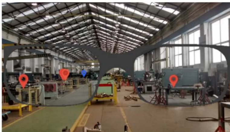
Σχήμα 3-20: Σημειώσεις γεωαναφοράς – απεικόνιση σε γυαλιά AR (Fraga-Lamas et al 2018)
