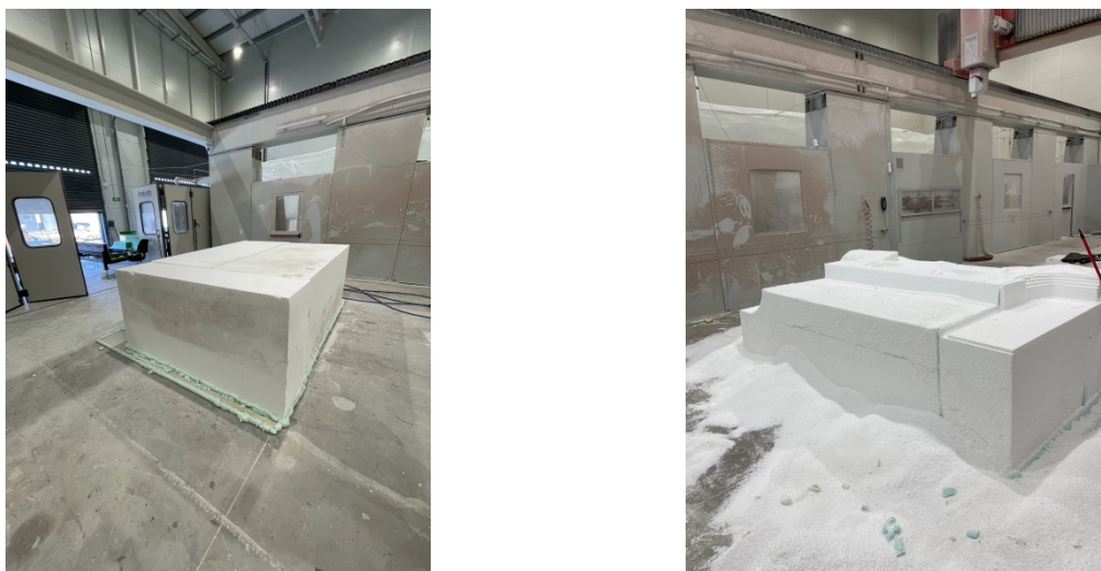
Σχήμα 4-2: Μπλοκ αφρού πριν (αριστερά) και μετά (δεξιά) από την κοπή
