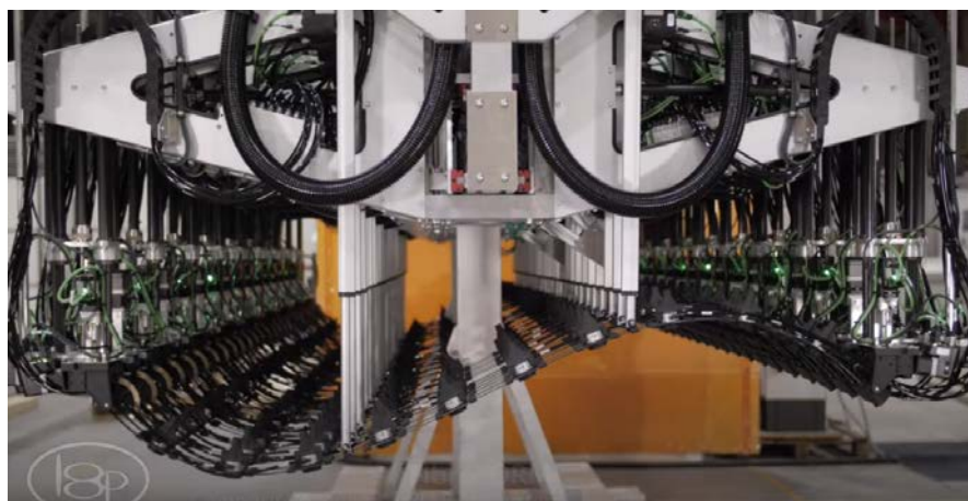
Σχήμα 3-34: Ο τελικός τελεστής FibreFORM ® της Loop Technology ενώ αλλάζει μορφή σύμφωνα με τις οδηγίες από το CAD πρόγραμμα
