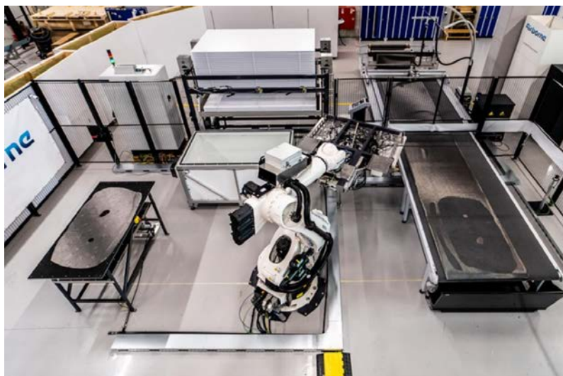
Σχήμα 3-32: Διάταξη τοποθέτησης υφασμάτων από τον πάγκο κοπής (δεξιά) στον πάγκο που θα γίνει η έγχυση της ρητίνης (Airborne) (Nehls 2022)
