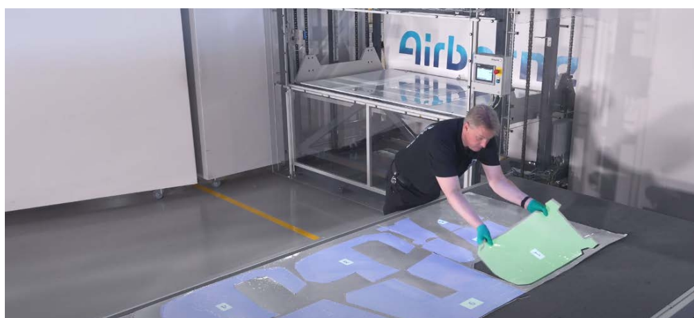
Σχήμα 3-11: Προβολή αρίθμησης πάνω στα υφάσματα με τη χρήση προτζέκτορα
