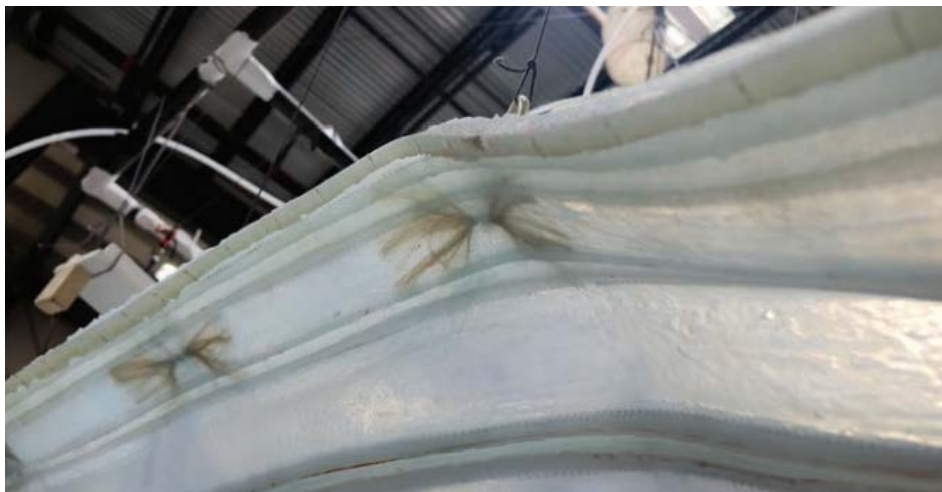
Σχήμα 3-13: Μεμβράνη από σιλικόνη ενώ είναι σηκωμένη μέσω κατάλληλης διάταξης
