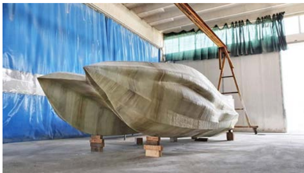
Σχήμα 3-40: Αριστερά αφότου έχουν κολληθεί τα εκτυπωμένα κομμάτια και δεξιά το τελικό σκάφος βαμμένο (3dnatives.com)
