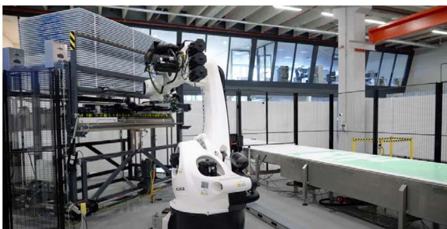
Σχήμα 3-10: Τοποθέτηση κομμένων υφασμάτων στο κατάλληλο kit
