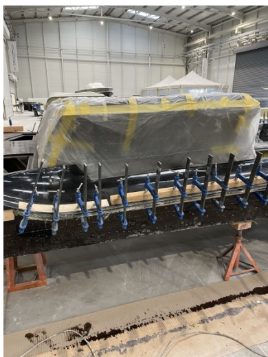
Σχήμα 4-11: Κόλληση δύο πολύστρωτων κομματιών
