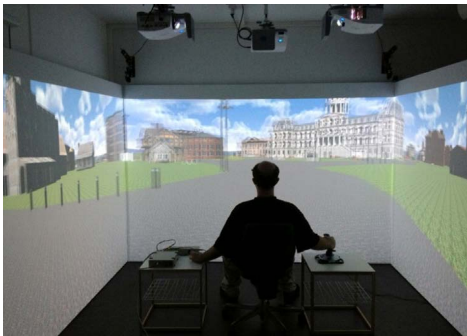
Σχήμα 2-13: Τεχνολογία CAVE (VR) (cog.ethz.ch/)
