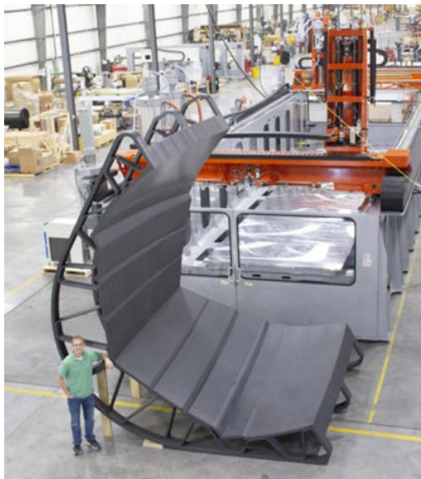
Σχήμα 3-42: Κομμάτι του καλουπιού ολοκληρωμένο (3dnatives.com)
