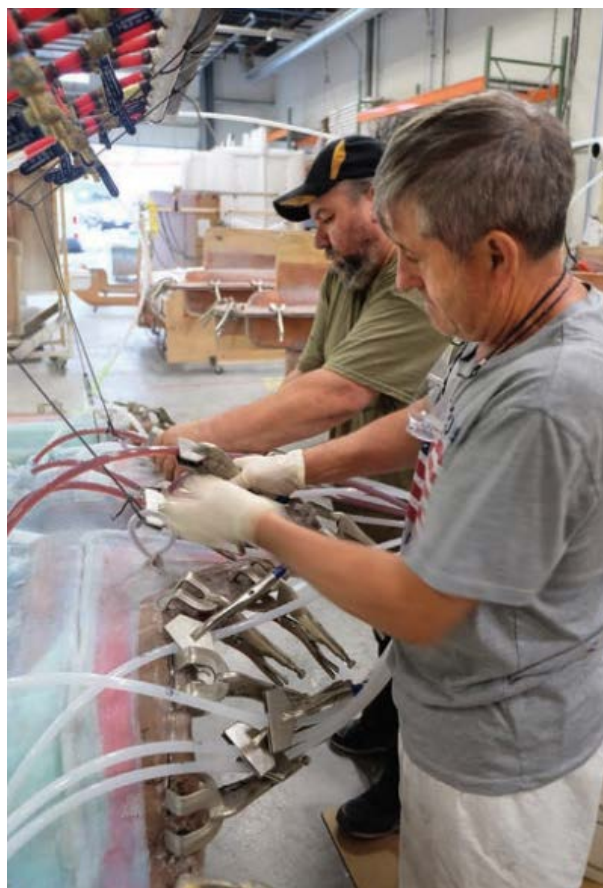
Σχήμα 3-16: Έλεγχος των σωλήνων τροφοδοσίας και διακοπή ροής όπου χρειάζεται, ανάλογα με το μέτωπο της ρητίνης
