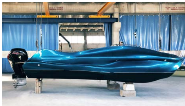
Σχήμα 3-40: Αριστερά αφότου έχουν κολληθεί τα εκτυπωμένα κομμάτια και δεξιά το τελικό σκάφος βαμμένο (3dnatives.com)
