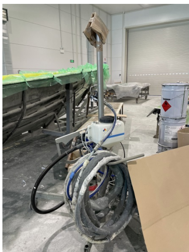
Σχήμα 4-9: Μηχάνημα εναπόθεσης gel coat
