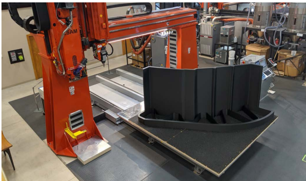
Σχήμα 3-41: Μηχάνημα LSAM της Thermwood εκτυπώνει κομμάτι καλουπιού για την κατασκευή πλαστικού σκάφους μήκους 51 ft. (3dnatives.com)
