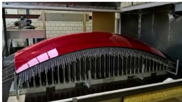
Σχήμα 3-23: Το καλούπι της Curveworks ενώ παρουσιάζει καμπύλη μορφή
