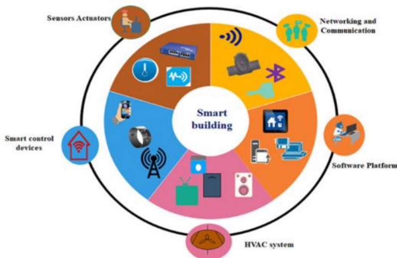
Εικόνα 4: Συστατικά μέρη ενός έξυπνου κτιρίου
