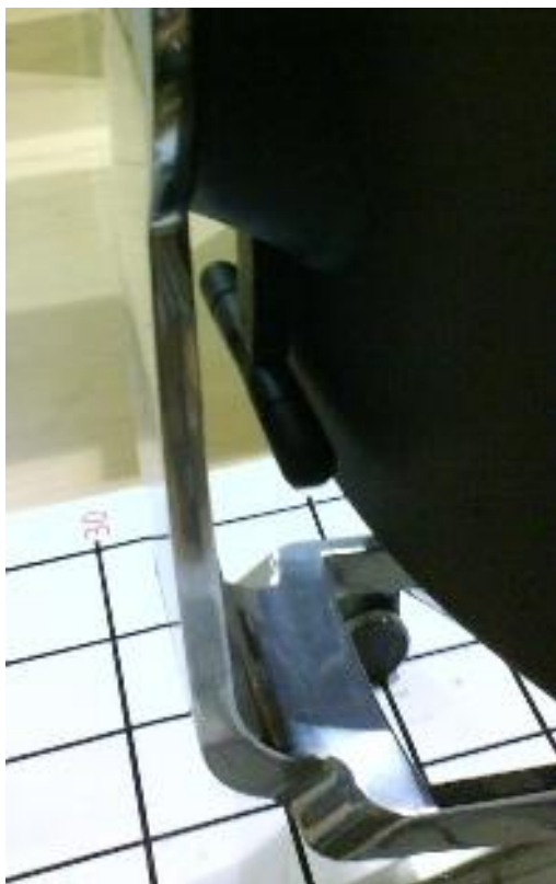
Εικ 3.6 Ενιαία λαβή ρύθμισης ύψους οσφυϊκής στήριξης (σταθερή τροχιά), χωρίς ρύθμιση πάχους της στήριξης
