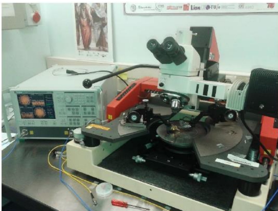
Εικόνα 24: Η πειραματική διάταξη που περιγράφηκε παραπάνω. Στην εικόνα φαίνονται: ο ραδιοκυματικός σταθμός βάσης, το οπτικό μικροσκόπιο και ο διανυσματικός αναλυτής δικτύου (VNA).
