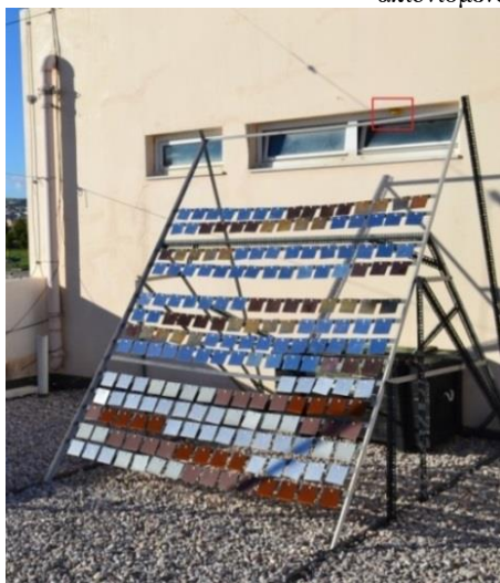
ΕΙΚΟΝΑ 21: Ατμοσφαιρική Έκθεση Μετάλλων στο Α/Δ Πάχης. Στο Πλαίσιο, ο Μετρητής Tinytag PLUS 2 με Αισθητήρα Θερμοκρασίας/Σχ. Υγρασίας.
