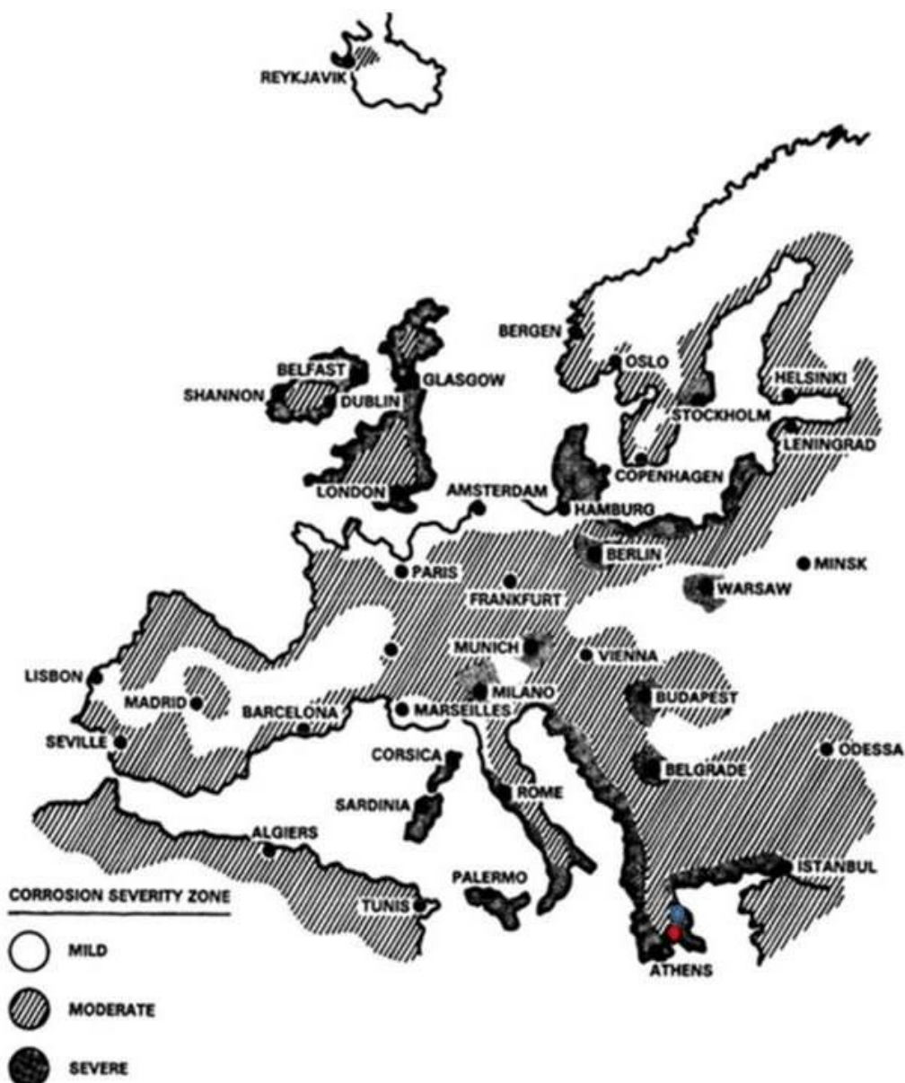
ΣΧΗΜΑ 31: Ευρωπαϊκός Διαβρωτικός Χάρτης [98]. Η βαθμονόμηση του Αεροδρομίου της Πάχης και του Στεφανοβικείου Ακολουθούν την Βαθμονόμηση της Ερυθράς και την Κυανής Θέσης των Α/Δ Πάχης Και Στεφανοβικείου Αντίστοιχα.
