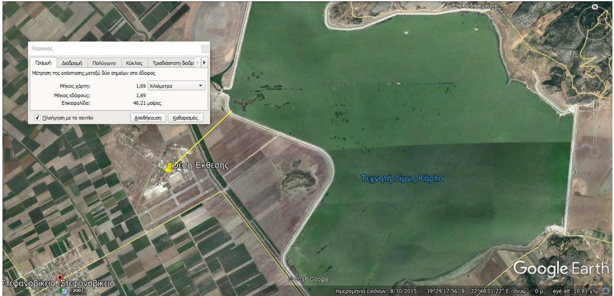
ΕΙΚΟΝΑ 13: Θέση Δοκιμών και Αισθητήρα Μέτρησης Θερμοκρασίας και Σχετικής Υγρασίας στο Α/Δ Στεφανοβικείου. Εύκολα Διαπιστώνεται ότι τα Μεταλλικά Δοκίμια Απέχουν Τουλάχιστον 1.5 χιλιόμετρο από τη λίμνη Κάρλα, ενώ Απέχουν Επίσης Πάνω από 21 Χιλιόμετρα από την Ακτογραμμή.
