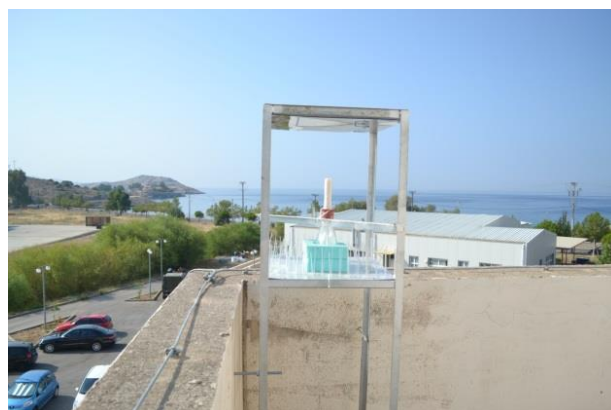
ΕΙΚΟΝΑ 22: Συσκευή που Χρησιμοποιήθηκε με Σκοπό τον Κατά ISO Προσδιορισμό του Ρυθμού Απόθεσης των Χλωριόντων στο Α/Δ Πάχης με τη Μέθοδο του «Υγρού Κεριού», σε Απόσταση 150μ. από την Ακτή.
