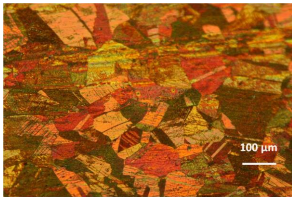
Εικόνα 4 : Χρωματική χημική προσβολή με αντιδραστήριο Klemm II (3 min) που αναδεικνύει τα μεταλλουργικά χαρακτηριστικά που εντοπίζονται στις άκρες του δείγματος ART1B κοντά στην διεπιφάνεια με την πάτινα σε μεγέθυνση (α) \times 100 και (β) \times 200 και προς το κέντρο του μεταλλικού πυρήνα σε μεγέθυνση (γ) \times 100 και (δ) \times 200 .
