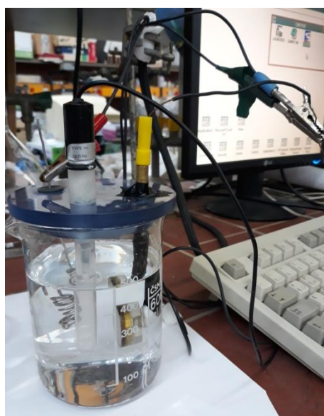
Εικόνα 14: Τα ηλεκτροχημικά κελιά χωρητικότητας (α) 500 mL και (β) 2 L που σχεδιαστηκαν για τις ανάγκες των διαφόρων ειδών ηλεκτροχημικών μετρήσεων.
