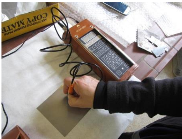
Εικόνα 3: Το φορητό όργανο μέτρησης πάχους μη αγώγιμων επιφανειακών στρωμάτων και επικαλύψεων σε μέταλλα (Elcometer 256FN).
