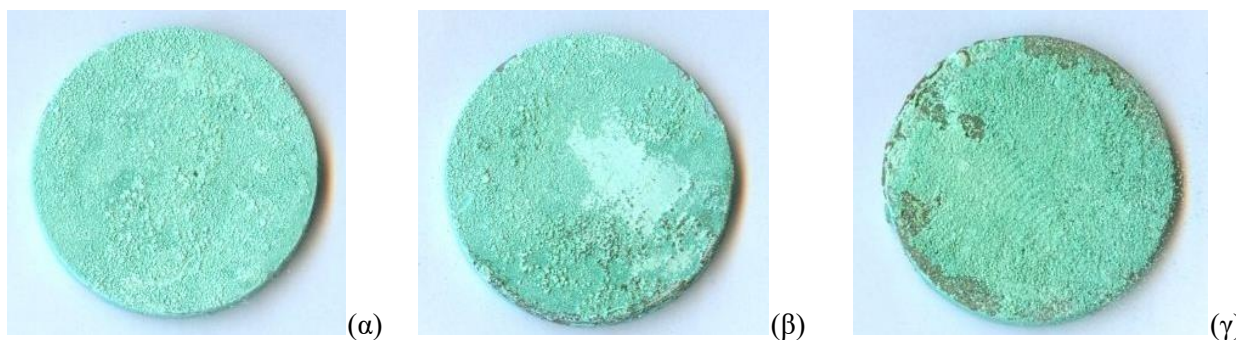
Εικόνα 1: Τεχνητές πάτινες που παράχθηκαν σε τριμερές κράμα TB, διαφοροποιώντας τη χρονική διάρκεια των δύο πειραματικών σταδίων του: (α) 24h + 24h, (β) 24h + 48h και (γ) 72h + 5h παραμονής σε διάλυμα χημικής προσβολής και σε θάλαμο με 100% RH αντίστοιχα.
