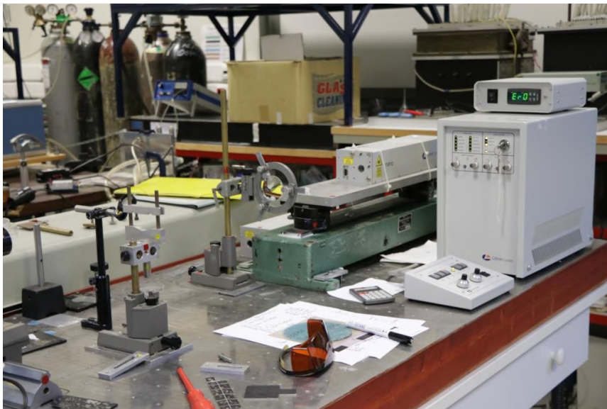
Εικόνα 16: Η πειραματική διάταξη του παλμικού Nd:YAG laser (πηγή ακτινοβολίας, ηλεκτρικά, μηχανικά και οπτικά συστήματα) που χρησιμοποιήθηκε για τις δοκιμές καθαρισμού.
