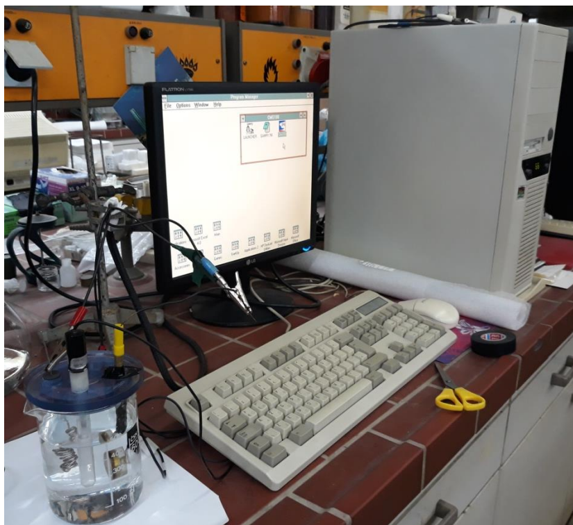
Εικόνα 13: Τα βασικά μέρη του ηλεκτροχημικού συστήματος που χρησιμοποιήθηκε για τα πειράματα του Κεφαλαίου 5.
