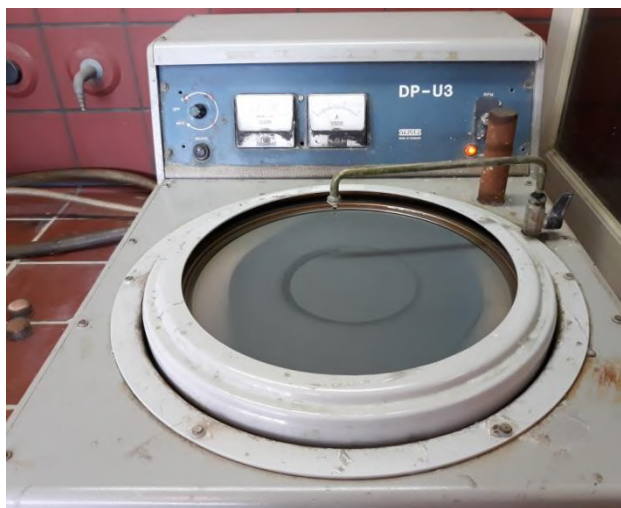
Εικόνα 10: Ηλεκτρικό περιστρεφόμενο τριβείο για λείανση και στίλβωση
