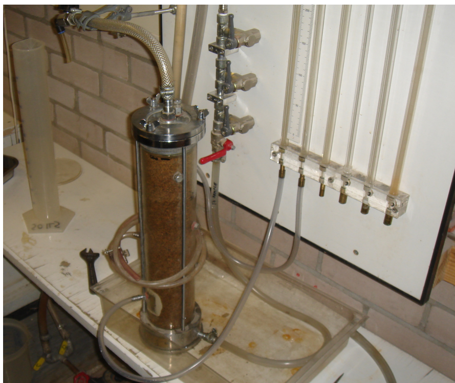
Σχήμα 5.35: Περατόμετρο σταθερού φορτίου που χρησιμοποιήθηκε για τη μέτρηση της διαπερατότητας της άμμου στο εργαστήριο Hyder Hydraulics
