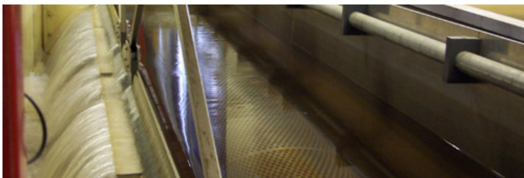
Σχήμα 5.2: Υπερχειλιστής (αριστερά), διάτρητος σωλήνας για την παροχή νερού στην δεξαμενή (μέσο) και περατό χωρίσμα (δεξιά)
