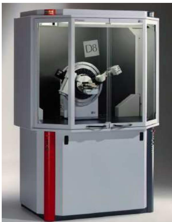
Εικόνα 4.4. Περιθλασίμετρο ακτίνων-Χ Bruker D8 Focus της Σχολής Μηχανικών Μεταλλείων Μεταλλουργών (Εθνικό Μετσόβιο Πολυτεχνείο).
