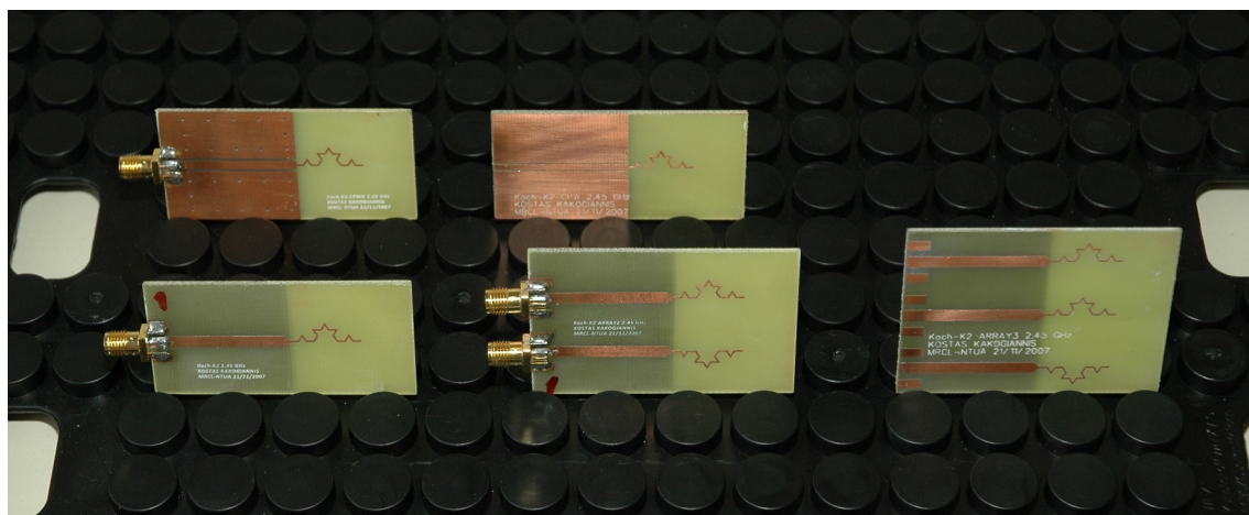
Σχήμα 3.1: Μονοπολικές κεραίες και στοιχειοκεραίες δύο και τριών στοιχείων βασισμένες σε φράκταλ καμπύλη τύπου von Koch.
