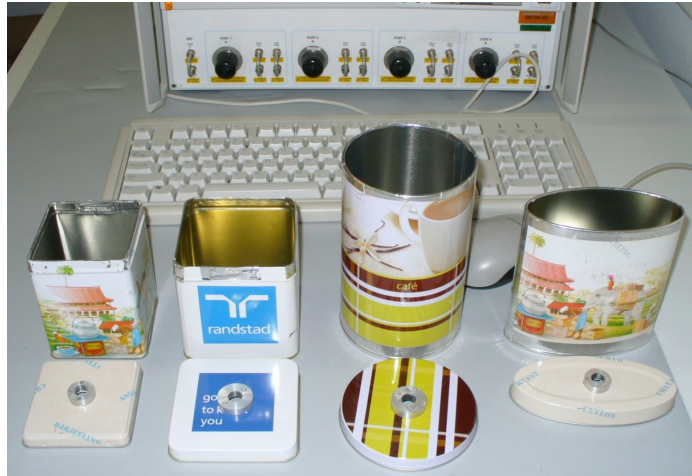
Σχήμα 7.21: Το δεύτερο σετ κοιλοτήτων Wheeler του ΕΚΡ/ΕΜΠ. Από αριστερά προς τα δεξιά διακρίνονται δύο παραλληλεπίπεδες, μία κυλινδρική Τύπου Α και ένας ελλειπτικός κύλινδρος.
