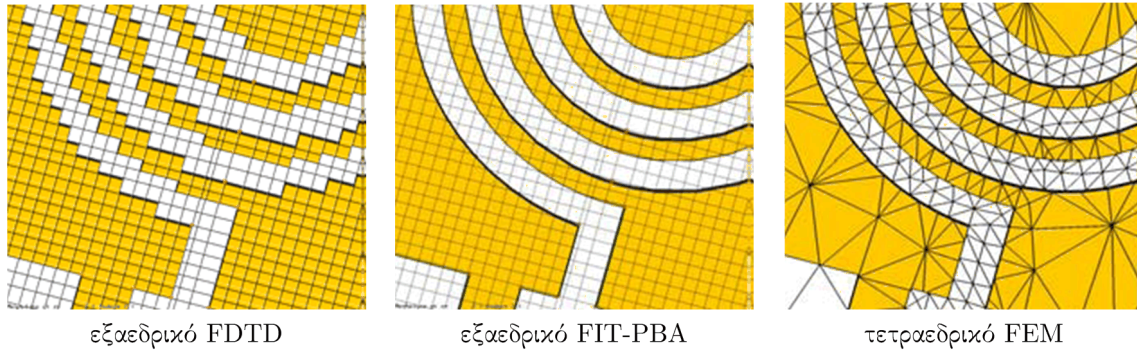
Σχήμα Α΄.2: Χωρική διακριτοποίηση του H/M μοντέλου ενός τυπωμένου σπειροειδούς πηνίου με χρήση των τριών διαφορετικών υπολογιστικών τεχνικών (© I. Munteanu, CST AG, 2005).
