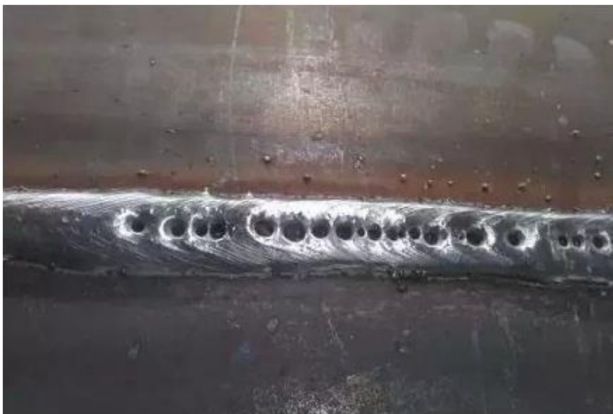
Σχήμα 29. Πόροι σε επιφάνεια συγκόλλησης. [27]
