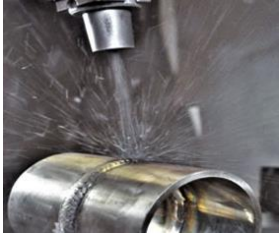
Σχήμα 12. Σφαιροβολή σε συγκόλληση κυλινδρικού αγωγού [9].
