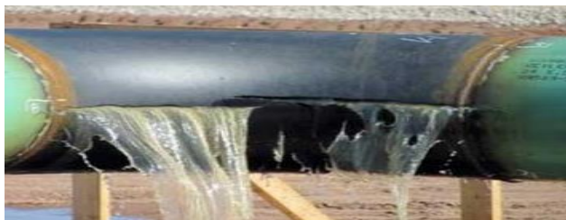
Σχήμα 9. Υδραυλική δοκιμή πίεσης σε αγωγό με τελική αστοχία και διαρροή. [6]
