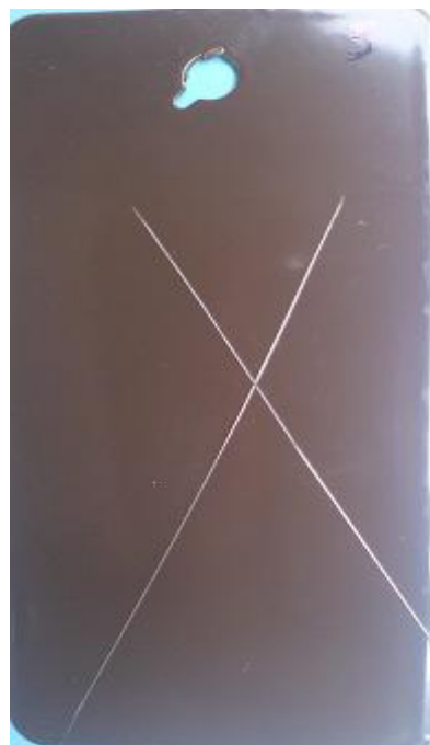
Εικόνα 5.4.10β: Δοκίμιο T15.112 (5) μετά την έξοδο από το θάλαμο.
