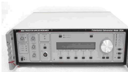
Εικόνα 4.20: Ποτεσιονστάτης / Γαλβανοστάτης της Applied Research μοντέλο 263A, που χρησιμοποιήθηκε στις μετρήσεις μεταβολής δυναμικού.
