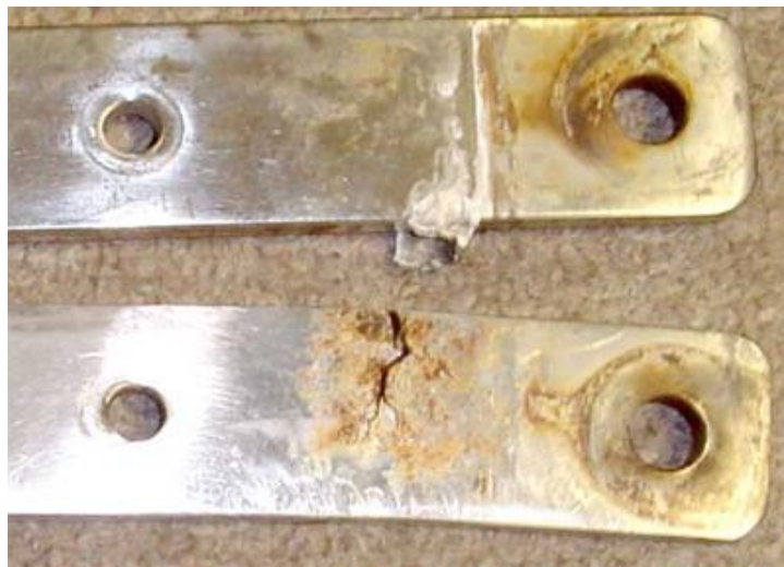
Εικ.2.14: Δείγμα διάβρωσης σε σχισμές
