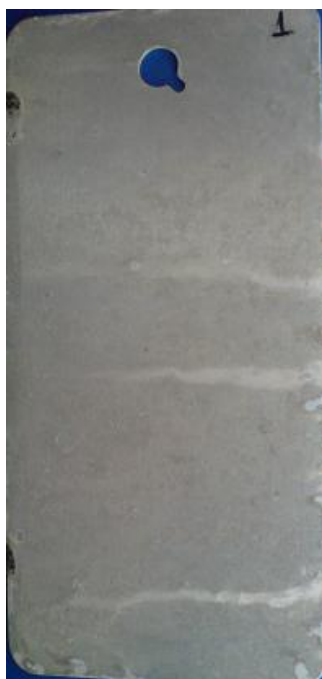
Εικόνα 5.4.7β: Δοκίμο αναφοράς T15.000 μετά την έξοδο από το θάλαμο
