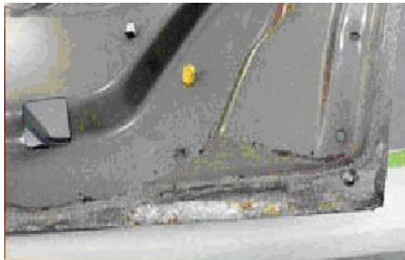
Εικ.2.10: Δείγμα νηματοειδούς διάβρωσης σε κράμα Al-6060
