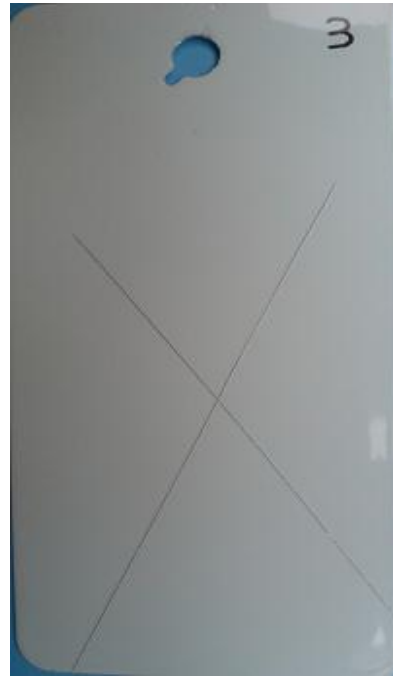
Εικόνα 5.4.9β: Δοκίμιο T15.111 (3) μετά την έξοδο από το θάλαμο.
