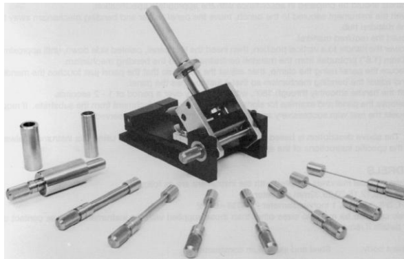
Εικόνα 4.28: Όργανο δοκιμής ευκαμψίας σε κυλινδρικό άξονα
