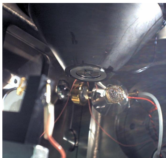
Εικόνα 4.10: Εσωτερικό του θαλάμου του Ηλεκτρονικού Μικροσκοπίου Σάρωσης (SEM)
