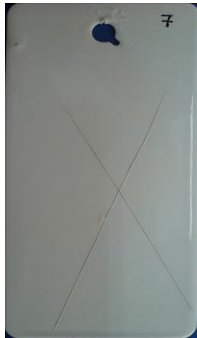
Εικόνα 5.4.12β: Δοκίμιο T15.103 (7) μετά την έξοδο από το θάλαμο
