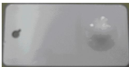
Εικόνα 5.4.13: Δοκίμιο T15.111 μετά από δοκιμή κοίλανσης
