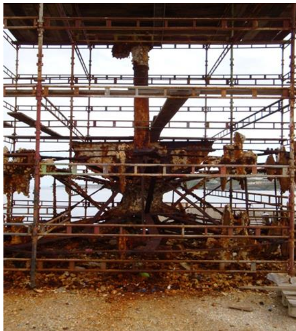
Εικόνα 3.11: Η κατάσταση και τοποθέτηση του τροχού του ατμόπλοιου «Πατρίς», μετά την ανέλκυσή του από την θάλασσα.
