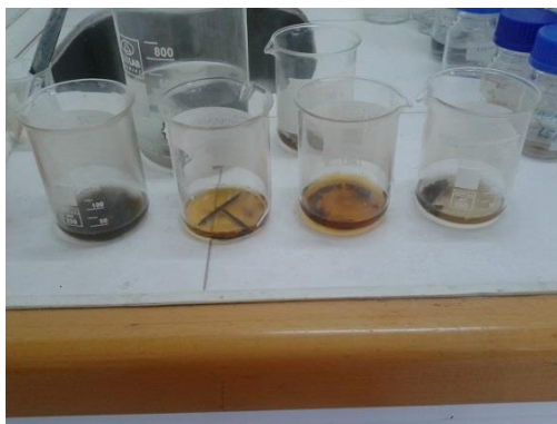
Εικόνα 3.35: Δείγματα δοκιμίων σε διάλυμα HNO 3 5N.
