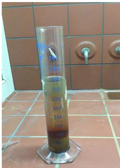
Εικόνα 3.36: Δοκίμιο αναφοράς βυθισμένο σε διάλυμα 5N HNO 3 .
