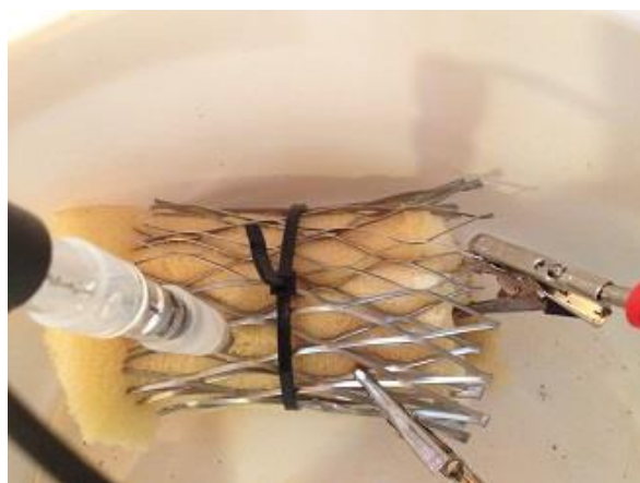
Εικόνα 3.34: Η πειραματική διαδικασία της ηλεκτρόλυσης με το πλέγμα του ανοξείδωτου χάλυβα.
