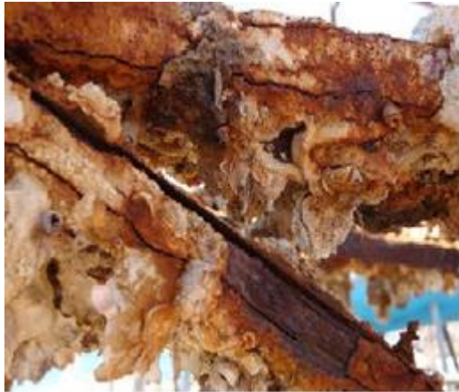
Εικ 3.14: Χαλαρά συνδεδεμένα συμπήγματα με το μέταλλο.
