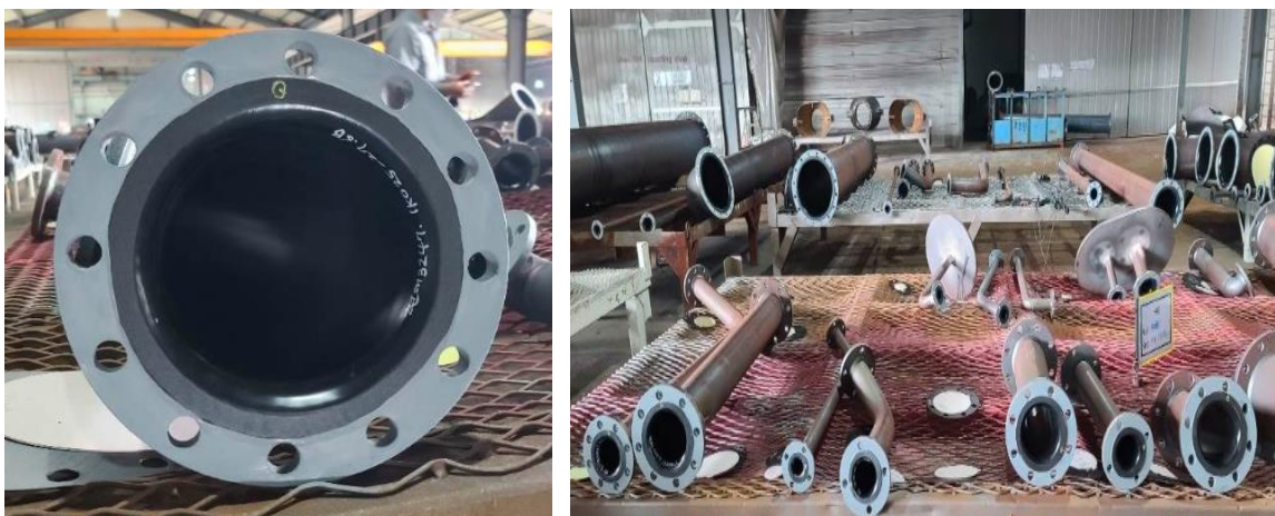
Σχήμα 5.11 Σωληνώσεις θαλασσινού νερού πλοίου VLCC κατασκευής Κορέα 2022, κατά την επιθεώρηση του στρώμα πολυαιθυλενίου τους
