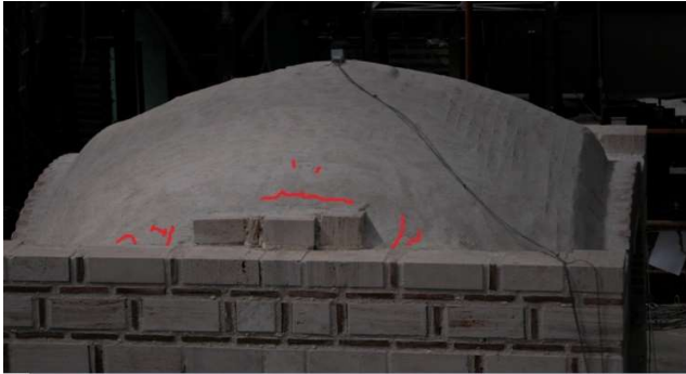
Σχήμα 4.52. Εικόνα πειράματος. Ρωγμές στο σταυροτόλιο
