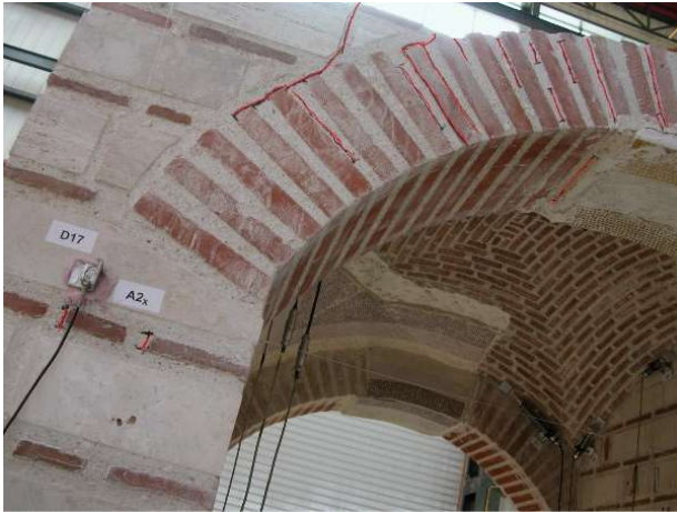
Σχήμα 4.58. Εικόνα από πείραμα. Ρωγμές στο τόξο του σταυροθολίου, στη σύνδεση με την τοιχοποιία
