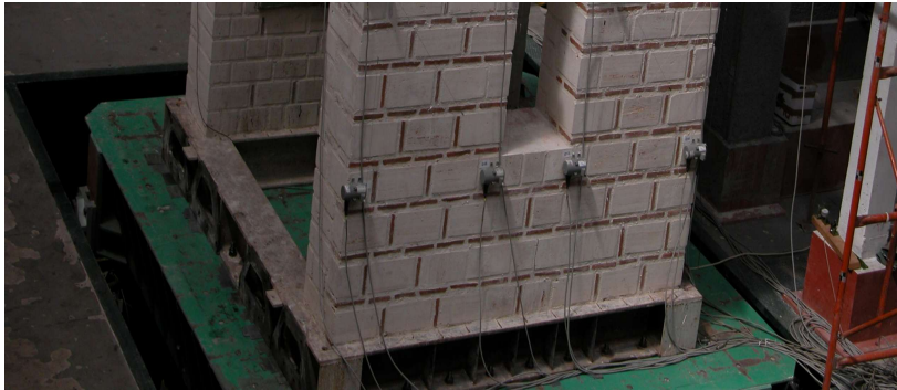
Σχήμα 4.64. Εικόνα πειράματος. Ρωγμές στη βάση της τοιχοποιίας
