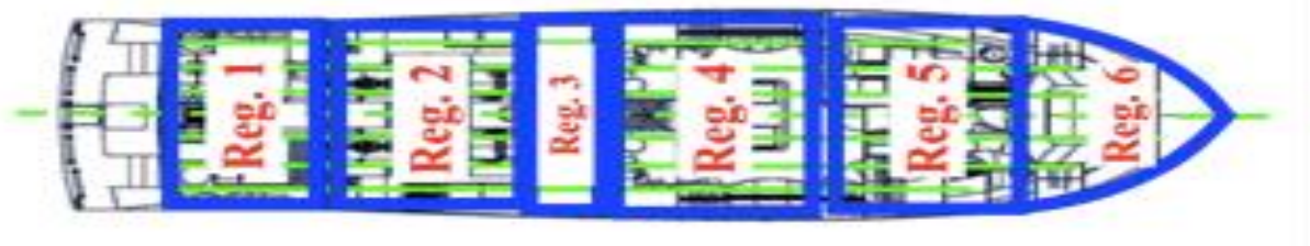
Σχήμα 4.27: 1 ο Σενάριο, Διάγραμμα Section Modulus διαμήκων ενισχυτικών - DNV
