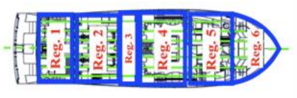
Σχήμα 4.7: Περιοχές του σκάφους προς ενίσχυση
