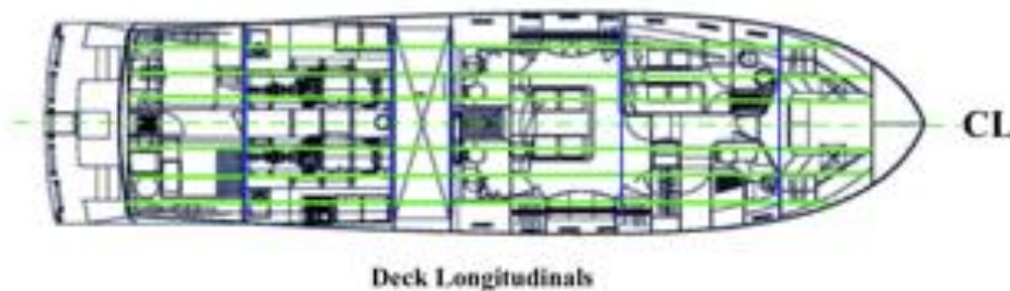
Σχήμα 4.1: Διαμήκη ενισχυτικά στο κατάστρωμα του σκάφους
