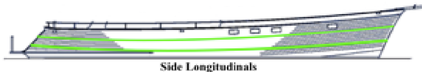
Σχήμα 4.2: Διαμήκη ενισχυτικά στην πλευρά του σκάφους
