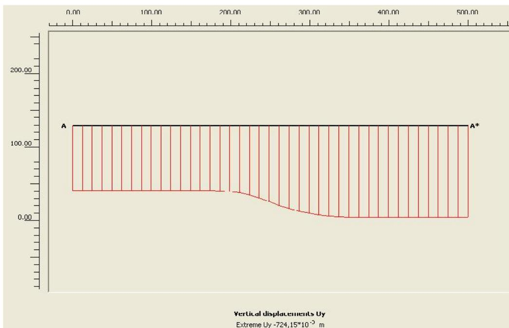
**Σχήμα Α.41:** Κατανομή των κατακόρυφων μετακινήσεων σε τομή κατά μήκος της επιφάνειας του εδάφους, στο μοντέλο προσομοίωσης με αναλογία άμμου – αργίλου 1:3 αριστερά και 1:6 δεξιά του ρήγματος, για πτώση στάθμης Υ.Ο. 10m.
