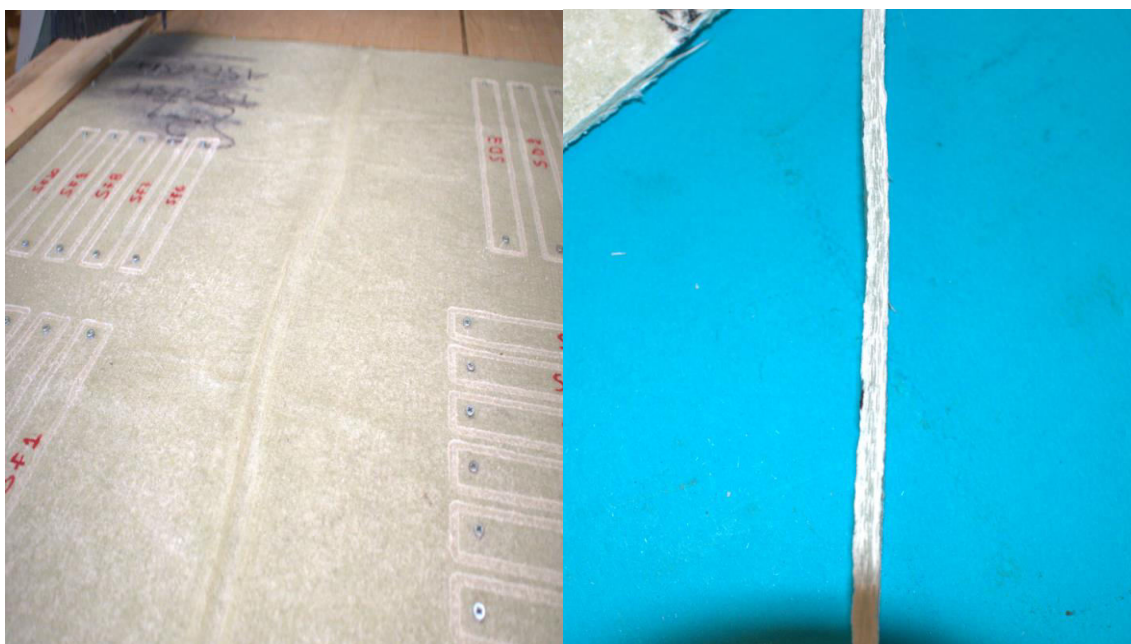
Σχήμα 2.22: πάνελ ενισχυτικών πριν την κοπή από CNC με αποτέλεσμα την δημιουργία εκκεντρων δοκιμίων.
