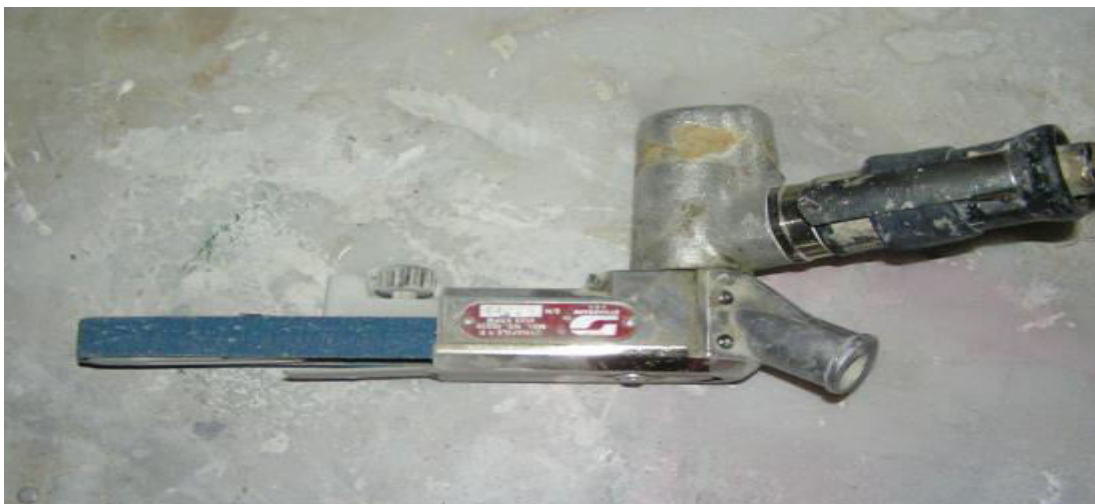
Σχήμα 1.34 : Κορδέλα γυαλόχαρτου διαφόρων πλατών ( 10-30 mm) που χρησιμοποιούνται σε περιπτώσεις που θέλουμε να λειάνουμε ακμές ή να επεξεργαστούμε περιοχές που είναι δύσκολα προσβάσιμες.
