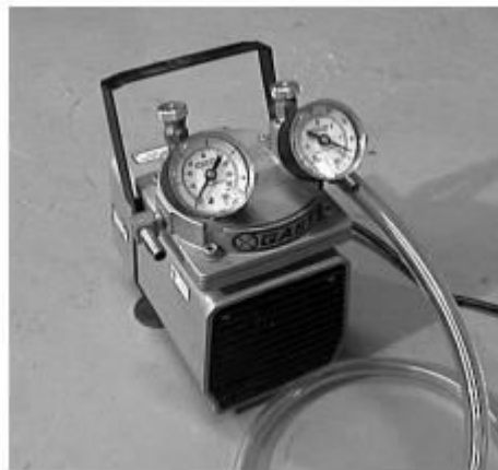
Σχήμα 1.58: αντλία διαφράγματος, μοντέλο 07061-40 1/8hp,1.2 CFM,24.0” Hg
