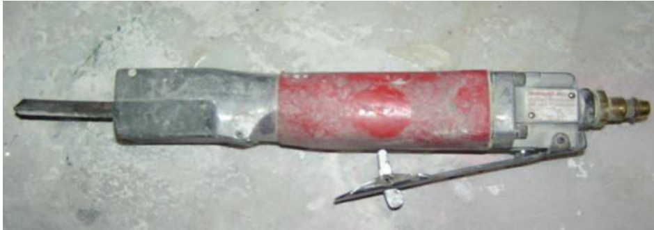
Σχήμα 1.29: Κοπτικό εργαλείο χειρός με λάμα από ζιργκόν (η λάμα αυτή δεν έχει δοντάκια), με το εργαλείο αυτό μπορούμε να ακολουθήσουμε πολύ δύσκολες γραμμές κοπής, με μοναδικό μειονέκτημα τη μικρή ταχύτητα κοπής. Χρησιμοποιείται για σύνθετα πάχους t \leq 5mm
