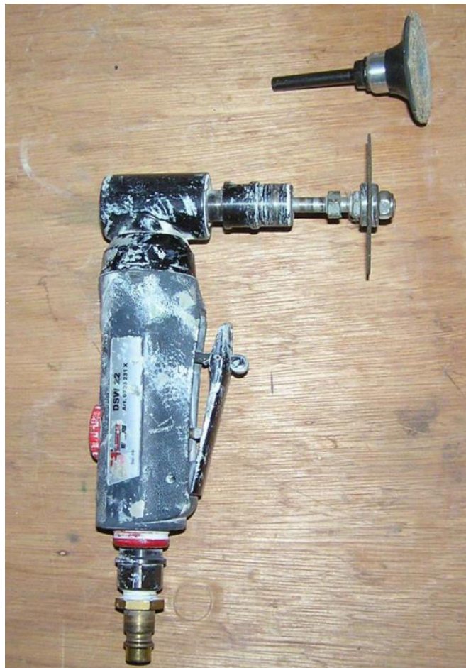
Σχήμα 1.28: Μικρός δίσκος κοπής ( εργαλείο αέρος ) διαμέτρου \varnothing 35 , ικανό να κόψει υλικά πάχους t \leq 5mm
