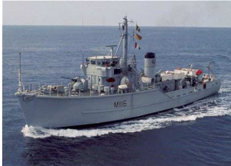
Σχήμα 1.2 Ναρκαλιευτικό του βρετανικού ναυτικού κατασκευασμένο από FRP.
