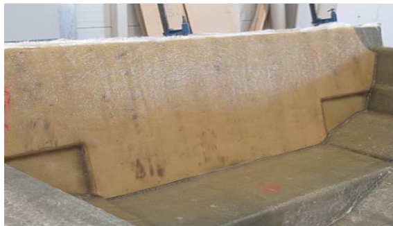
Σχήμα 1.19 : Χρήση κόντρα-πλακέ σε πρύμνη καθρέπτη
