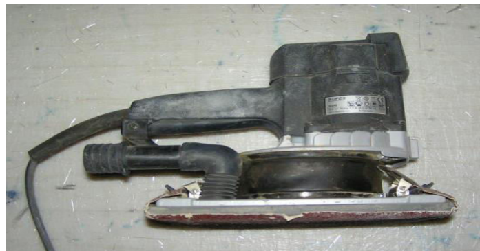
Σχήμα 1.37 :Παλμικό τριβείο, το οποίο κινείται παλμικά προς μια διεύθυνση και τρίβει την εσωτερική επιφάνεια του πολύστρωτου.
