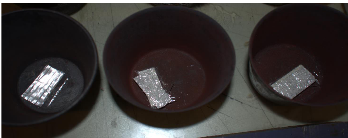
Σχήμα 2.12 : Ενισχυτικές ίνες μετά την καύση των δοκιμίων
