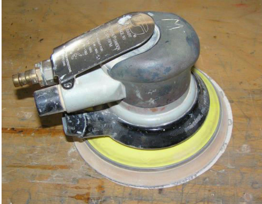
Σχήμα 1.36 :Τριβείο «χούφτα» αέρος. Προσαρμόζονται επάνω του στρογγυλά γυαλόχαρτα και με περιστροφική, έκκεντρη κίνηση τρίβει και διαμορφώνει την επιφάνεια του σύνθετου
