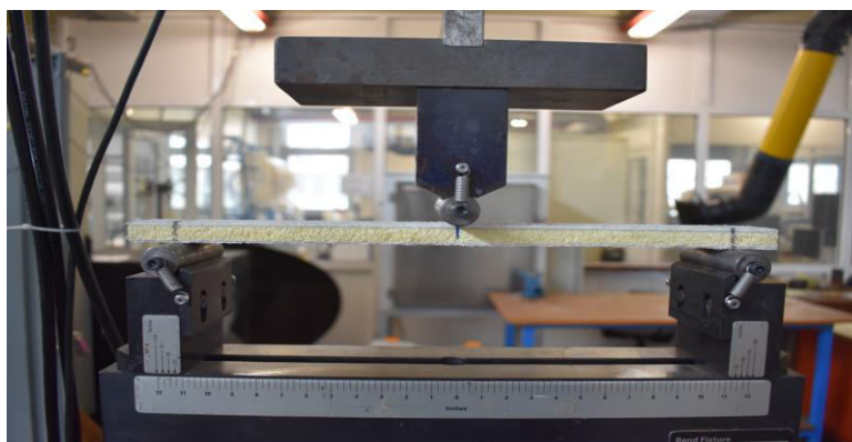
Σχήμα 2.28: Διάταξη πειράματος κάμψης
