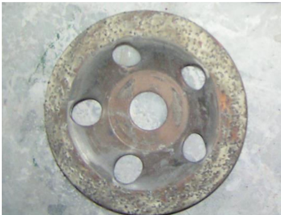
Σχήμα 1.39:Περιστροφικό εργαλείο τριβής για επιφάνειες που συγκολλούνται. Το εργαλείο αυτό έχει ένα μεταλλικό άκρο το οποίο το ίδιο έχει άγρια επιφάνεια και άρα δεν χρησιμοποιεί γυαλόχαρτα. Ονομάζεται εργαλείο «πέτρας». Είναι
