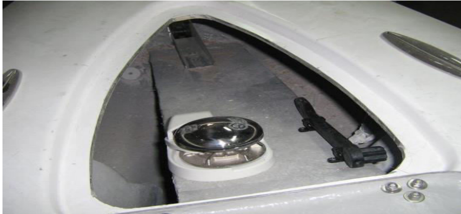
Σχήμα 1.27 : εσφαλμένη κοπή τρύπας για εργάτη άγκυρας
