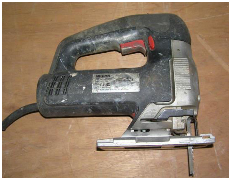
Σχήμα 1.30: Σέγα χειρός με λαμα από ζιργκόν ( στην συγκεκριμένη φωτογραφία το ζιργκόν έχει αντικατασταθεί από δοντάκια ). Το εργαλείο αυτό είναι συνήθως ηλεκτρικό και μας δίνει τη δυνατότητα να κόψουμε σύνθετα υλικά με σχετικά μεγαλύτερο πάχος από το κοπτικό εργαλείο χειρός με λάμα ( t \leq 8 - 10mm ) αλλά με μεγαλύτερη δυσκολία λόγω του μεγέθους του εργαλείου, του βάρους του και του καλωδίου.
