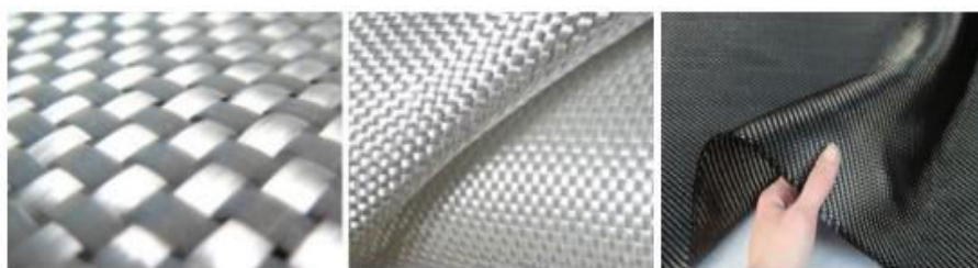
Σχήμα 1.7 : Υφάσματα πυκνής πλέξης. Ίνες γυαλιού (αριστερά και μέσον), ίνες άνθρακα (δεξιά)
