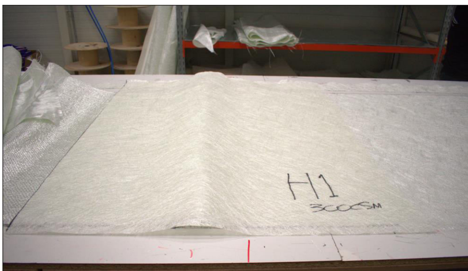
Σχήμα 2.3: Πρώτη στρώση 300CSM για γάστρα ( Hull )
