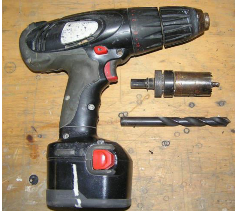
Σχήμα 1.35 : Δράπανο για δημιουργία τρυπών για βίδες ή για τρύπημα μεγαλύτερης διαμέτρου ( με ποτηροτρύπανα ) για τοποθέτηση εξαρτημάτων ( π.χ. φώτα, σωληνώσεις κτλ.)
