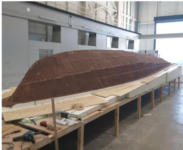
Σχήμα 1.14 : Κατασκευή αρσενικού καλουπιού με CNC
