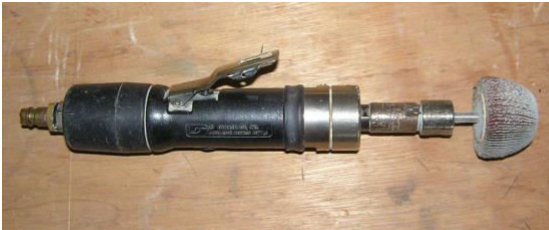
Σχήμα 1.32: Περιστροφικό εργαλείο (« σβουράκι ») αέρος, το οποίο αποτελείται από πολλά μικρά φύλλα γυαλόχαρτων που περιστρεφόμενα τρίβουν και κόβουν τον πολυεστέρα. Χρησιμοποιείται για τη διαμόρφωση του σόκορου των περιμέτρων κοπής ώστε να μην έχει κοφτερή ακμή, ή για τις ενώσεις δύο ακμών που θέλουμε να έχουν μια μικρή καμπυλότητα ( filleting ) μεταξύ τους και όχι γωνία.
