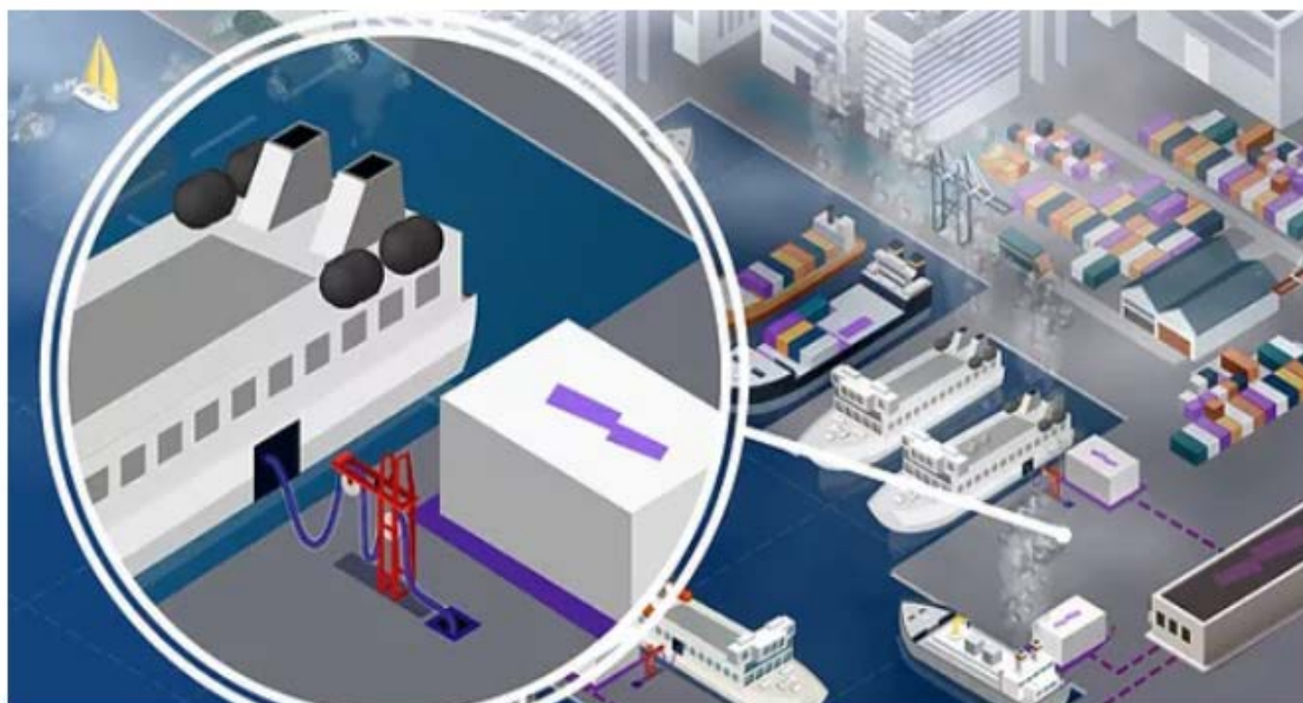
Εικόνα 15: Σχέδιο ηλεκτρικής διασύνδεσης πλοίου με λιμάνι (BALUCO, 2019)
