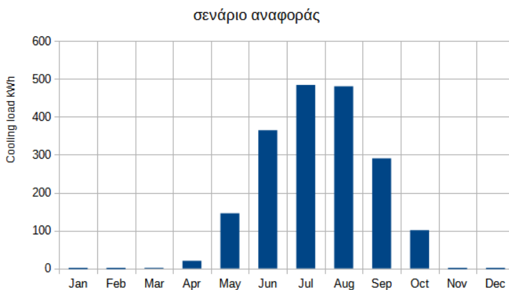
Εικόνα 5.29 Μηνιαίο ψυκτικό φορτίο (kWh / μήνα) - σενάριο αναφοράς
