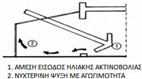
Εικόνα 1.35 Σύστημα θερμοκηπίου , Θερμική Συμπεριφορά Κτιρίων ΕΜΠ
