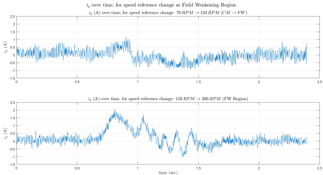
Σχήμα 5.38: Κυματομορφή ρεύματος i_q , σε μια βηματική μεταβολή της ταχύτητας αναφοράς, με Έλεγχο Εξασθένισης Πεδίου.
