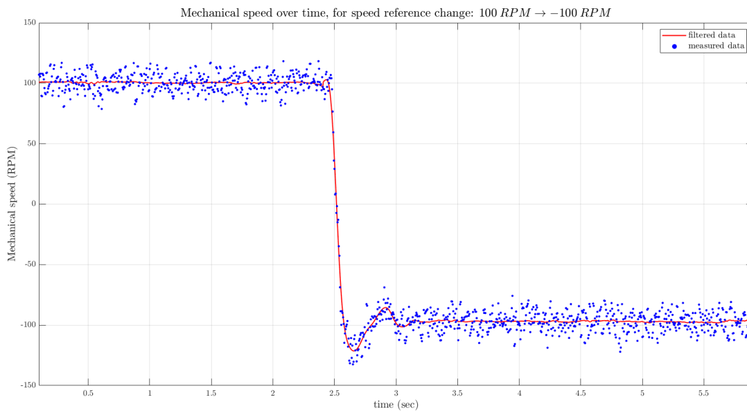
Σχήμα 5.23: Κυματομορφή μηχανικής ταχύτητας, σε μια βηματική μεταβολή της ταχύτητας αναφοράς, από 100 ΣΑΛ σε -100 ΣΑΛ, με Τροποποιημένο Μοντέλο Ρεύματος.
