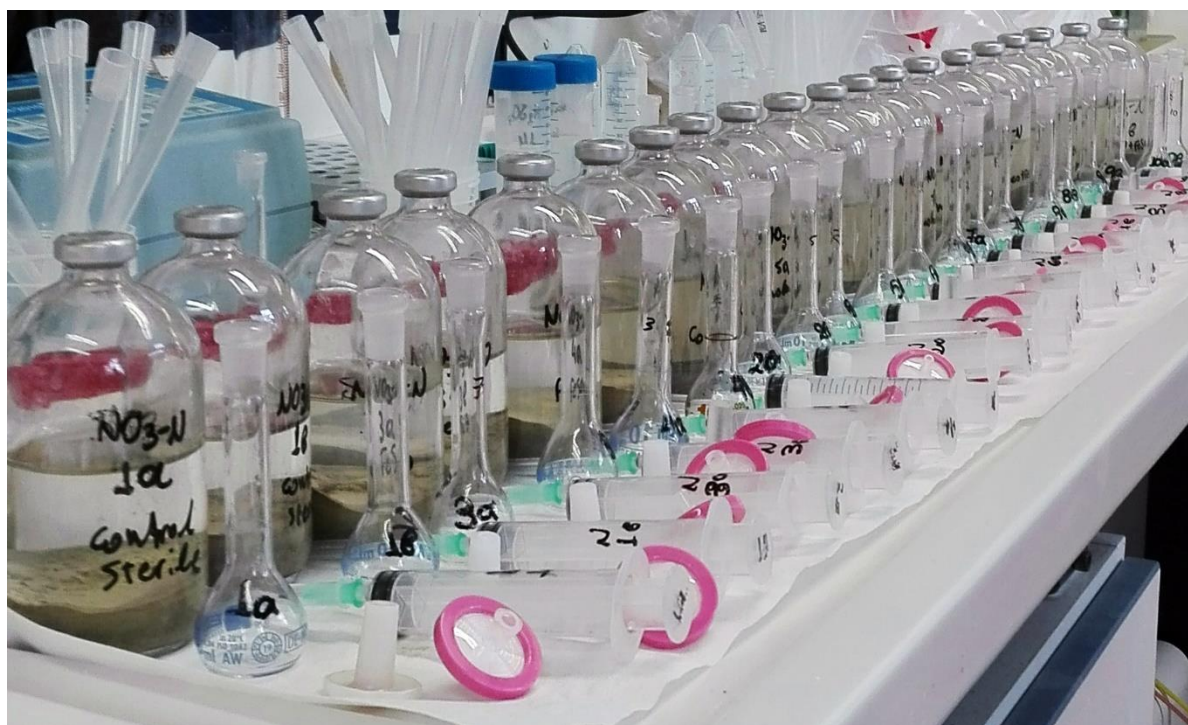
Σχήμα 3.1 Μπουκάλια serum στα οποία έχουν κατασκευαστεί μικρόκοσμοι. Απεικονίζονται επίσης σύριγγες δειγματοληψίας και φίλτρα σύριγγας για διήθηση των δειγμάτων.
