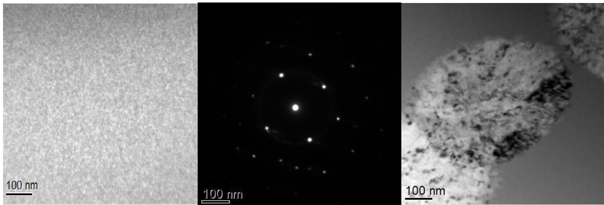
Σχήμα 2.41. Εικόνες TEM για το δείγμα \text{Fe}_{80}\text{B}_{20} , όπου φαίνεται η άμορφη κατάσταση στο δείγμα όπως παρήχθη (αριστερά), η κρυσταλλική απόκριση περίθλαση ηλεκτρονίων - SAED (κέντρο) και η νανοκρυστάλλωση (δεξιά).
