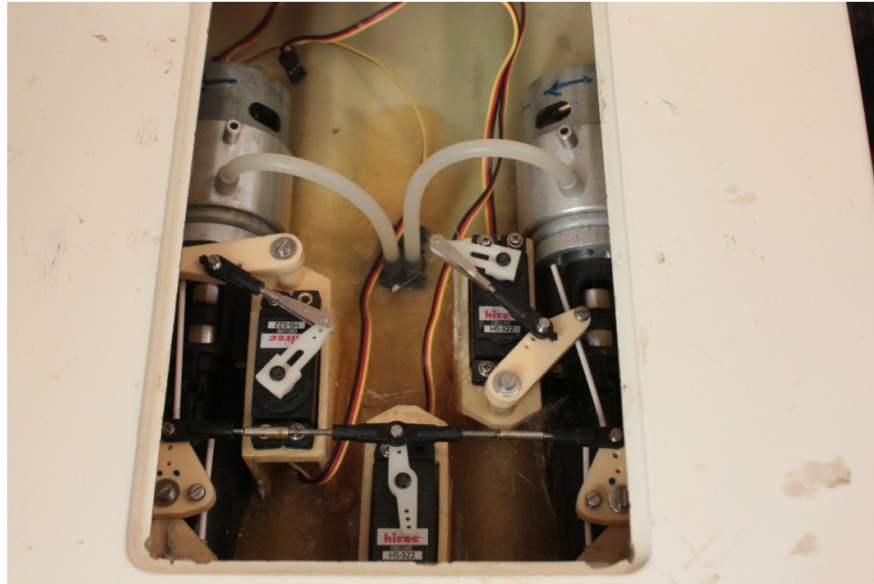
Εικόνα 3. Σερβομηχανισμοί ελέγχου εκτοξευτών και ηλεκτροκινητήρες πρόωσης.
