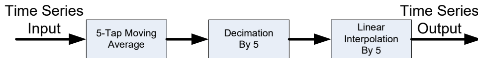
Σχήμα 2. Επεξεργασία σήματος για τη δημιουργία ομαλού σήματος γωνιακής επιτάχυνσης για την εκπαίδευση του νευρωνικού δικτύου συνεχούς χρόνου
