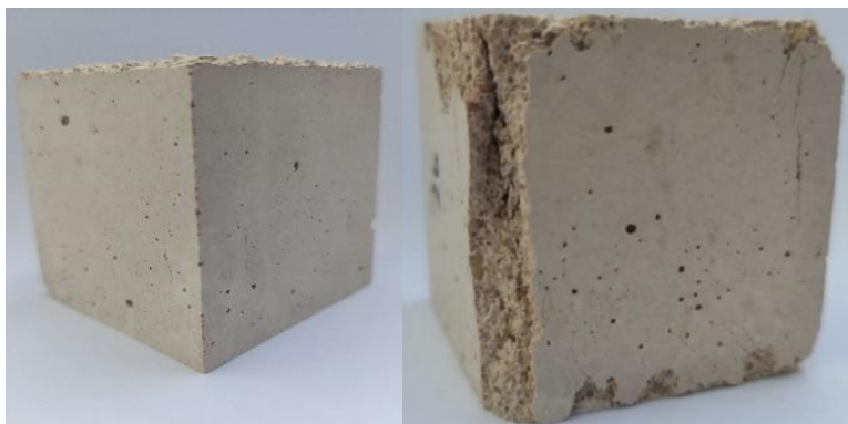
Εικόνα 9.12 Φωτογραφία του CMN_POZ_2 πριν (αριστερά) και μετά (δεξιά) την δοκιμή μονοαξονικής θλίψης.
