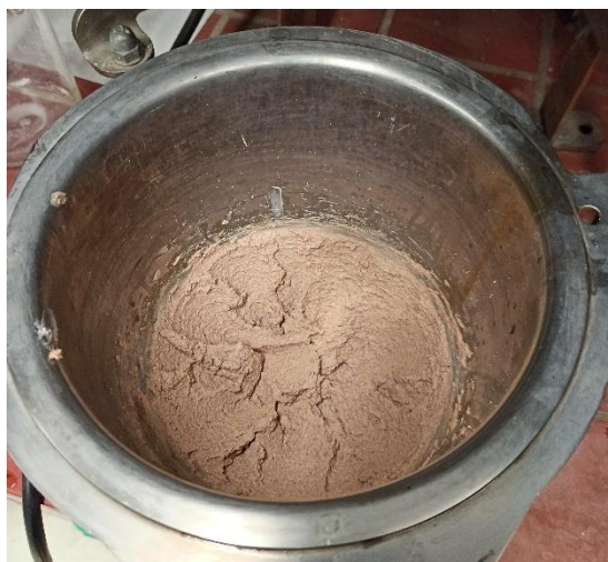
Εικόνα 9.1 Το μίγμα μαγνησιούχου συνδετικού υλικού και άμμου μετά το τέλος της ανάδευσης, πριν την χύτευση των κονιαμάτων στα καλούπια.
