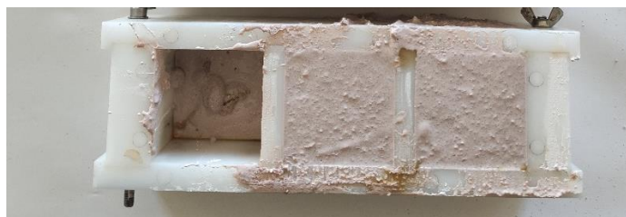
Εικόνα 9.10 Χύτευση των κονιαμάτων CMN_mp_1 και CMN_mp_2 σε καλούπια διαστάσεων 5x5x5 cm
