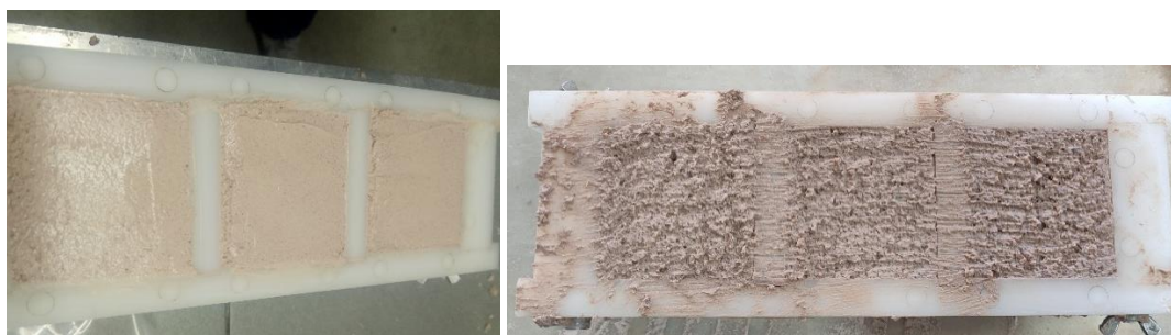
Εικόνα 9.2 Χύτευση κονιαμάτων σε καλούπια διαστάσεων 5x5x5cm
