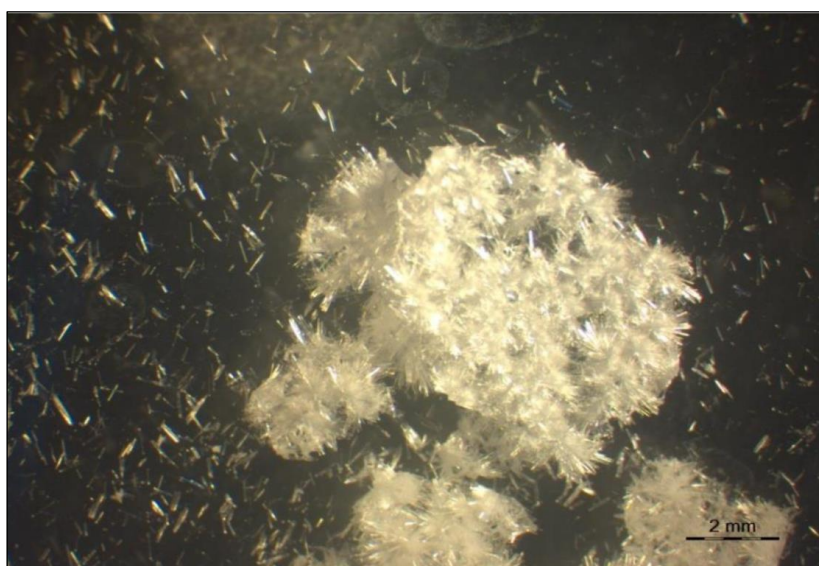
Εικόνα 6.3 Στερεοσκοπική εικόνα του συνθετικού νεσκεχονίτη, που παράχθηκε κατά την αντίδραση διαλύματος MgCl_2 \cdot 6H_2O με CO_2 και NaHCO_3 .
