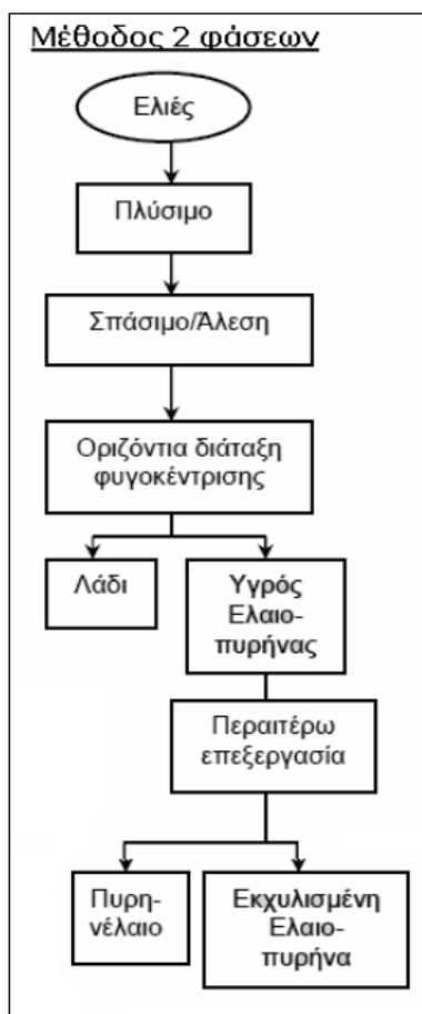
Σχήμα 3 Στάδια επεξεργασίας σε ελαιουργείο φυγοκεντρικού τύπου 2 φάσεων (Πηγή ΕΟΔΕΕ)
