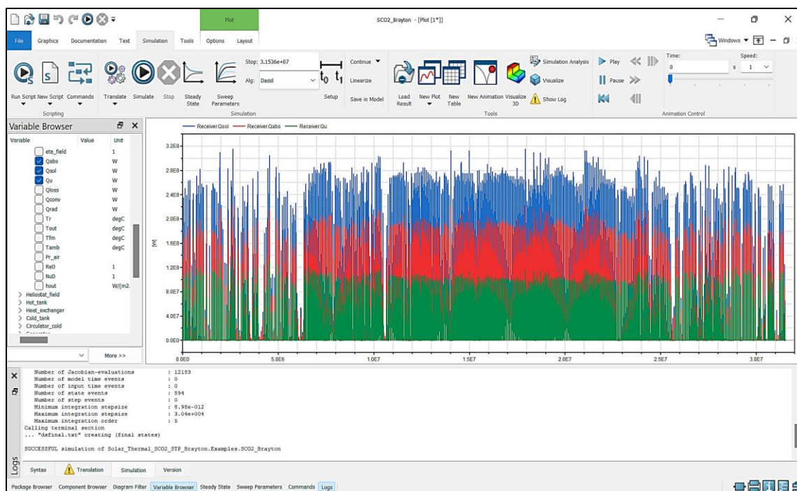
Εικόνα 208: Χρονική μεταβολή ωφέλιμης ισχύος (Receiver.Qu) σε σύγκριση με τη διαθέσιμη ηλιακή (Receiver.Qsol) και την απορροφούμενη ισχύ από τον κεντρικό δέκτη (Receiver.Qabs) στο λογισμικό Dymola [72]
