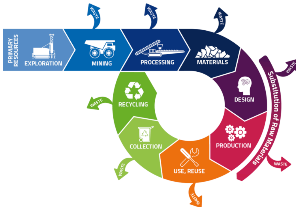
Σχήμα 4: Τα στάδια του κύκλου ζωής των ΟΠΥ. (EIT Raw Materials, 2018)
