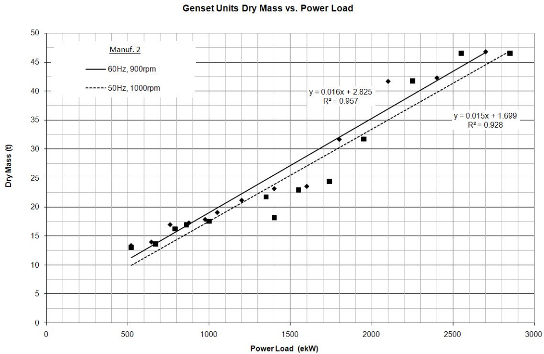
Σχήμα 3.43: Εκτίμηση του βάρους των ηλεκτρογεννητριών συναρτήσει του φορτίου – Κατ/στής 2 (60Hz, 50 Hz)
