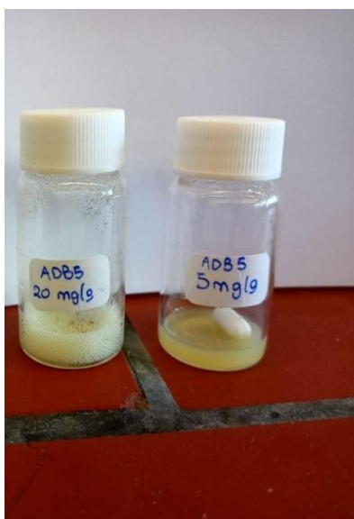
Εικόνα 26: Δημιουργία εγκλεισμών 5mg/g, 20mg/g με CAGE 1:1
