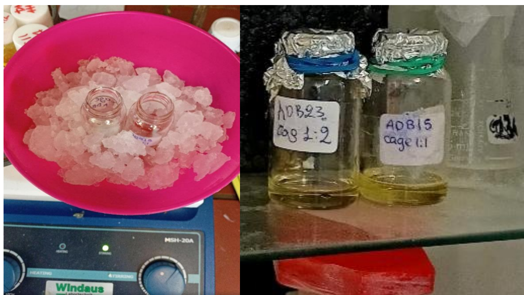
Εικόνα 22: Διαδικασία σχηματισμού CAGE 1:1 και CAGE 1:2 και τελικά προϊόντα
