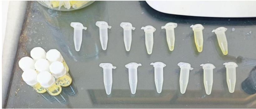
Εικόνα 24: Δημιουργία αραιώσεων των stock διαλυτότητας για μέτρηση στο UV-vis
