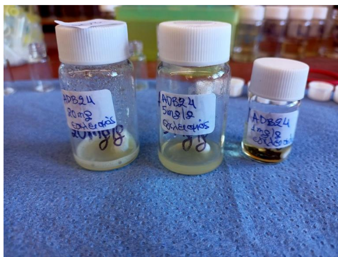
Εικόνα 27: Δημιουργία εγκλεισμών 1mg/g, 5mg/g, 20mg/g με CAGE 1:1
