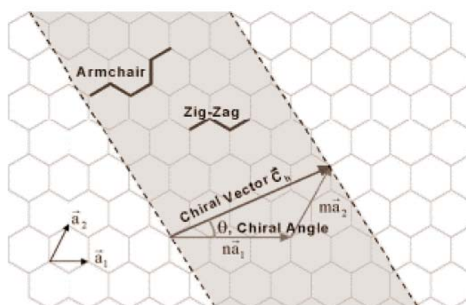
Σχήμα 1.4: Σχηματικό διάγραμμα στο οποίο εμφανίζεται ο τρόπος με τον οποίο τυλίγεται ένα γραφιτικό πλέγμα για να σχηματίσει νανοσωλήνα άνθρακα [15].
