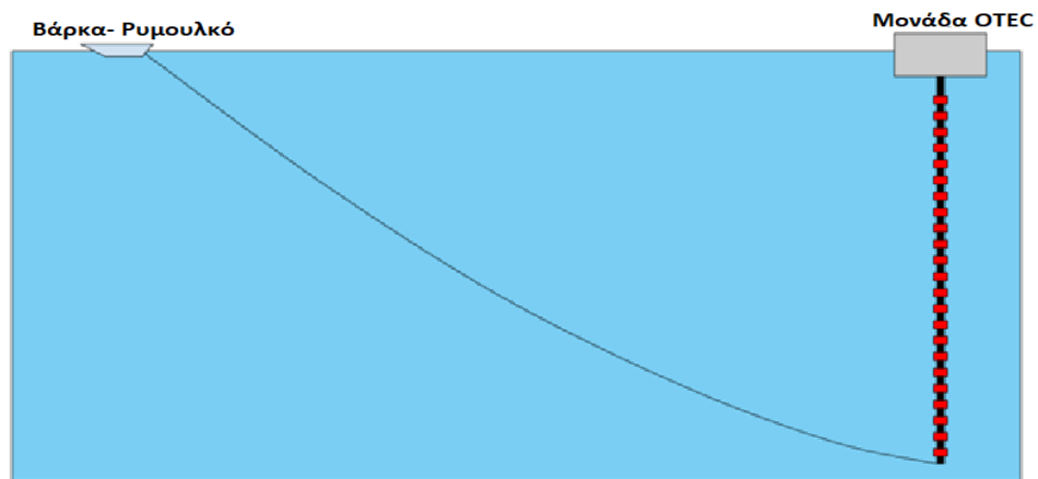
Εικόνα 17 Τελική θέση αγωγού
