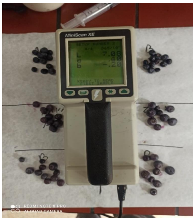
Εικόνα 13: η συσκευή Miniscan XE για την μέτρηση του χρώματος.
