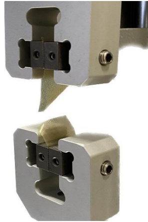
Εικόνα 16: Οι επικαλύψεις από άμυλο από φύκια-πηκτίνη (κάτω) και χιτοζάνη (πάνω) μετά τον εφελκυσμό τους για την αξιολόγηση των μηχανικών ιδιοτήτων τους.
