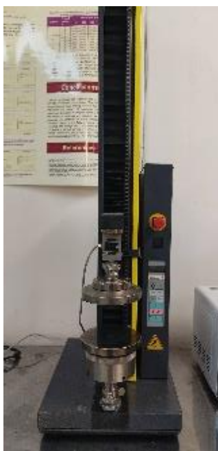
Εικόνα 12: Το μηχάνημα Texture Analyzer Zwick Materials Testing Z2.5/TN15 στο οποίο εξετάστηκαν οι μηχανικές ιδιότητες των φιλμ.
