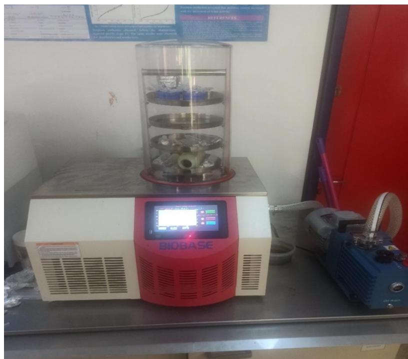
Εικόνα 11: το όργανο Freeze Dryer BK-FD10S.
