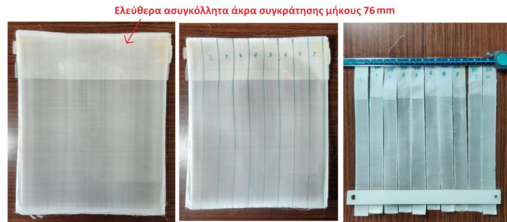
Προετοιμασία δοκιμών αποφλοίωσης.
