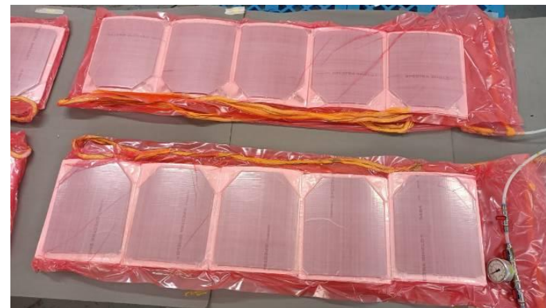
Πραγματική διάταξη συγκόλλησης του τελικού υβριδικού συνθέτου.
