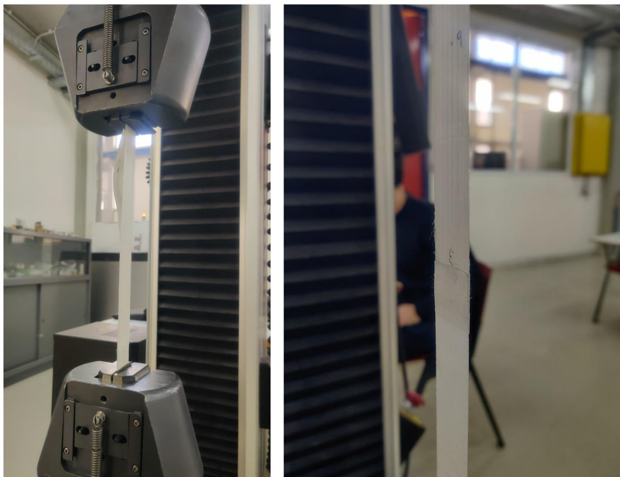
Εικόνα 137 : Δοκίμιο αποφλοίωσης μετά το πέρας της δοκιμής.
