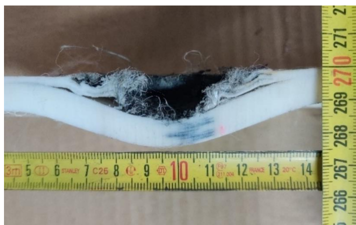
Εικόνα 93 : Τομή του μοναδικού σημείου βολής του δοκιμίου 1 με βλήμα M80 FMJ.
