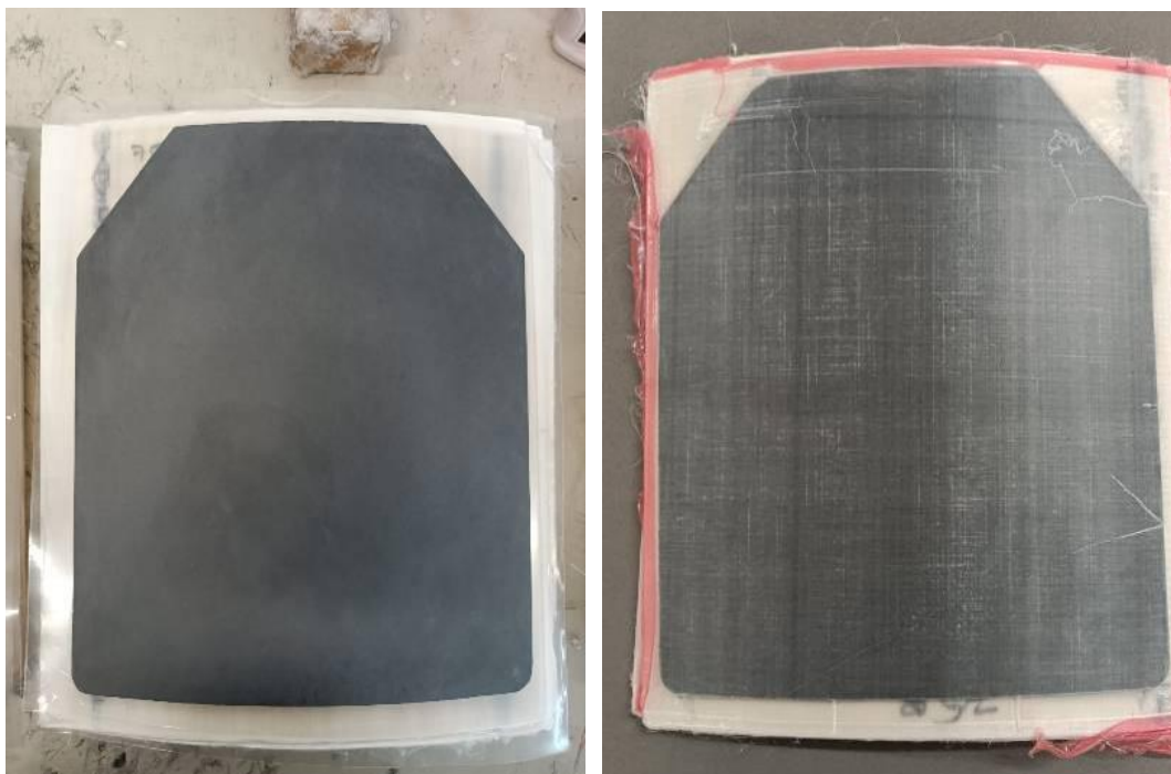
Εικόνα 74 : Θωράκιση χωρίς αντιθραυσματική προστασία και προ συγκόλλησης (αριστερά) και με αντιθραυσματική προστασία (δεξιά) κατόπιν συγκόλλησης [Φωτογραφικό αρχείο Βενετσάνου Βασιλείου Οδυσσέα].
