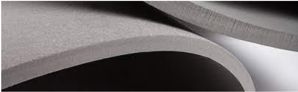
Εικόνα 67 : Τυπικό παράδειγμα βαλλιστικού αφρού της εταιρείας ZOTEK® N – Zotefoams [73].
