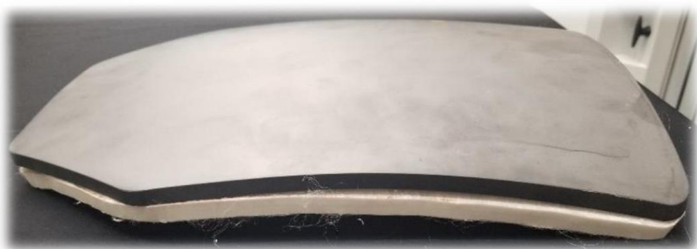
Εικόνα 70 : Προσαρμογή κεραμικής πλάκας πάνω πολύστρωτο σύνθετο, πριν τον κλίβανο [63].
