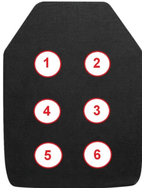
Εικόνα 69 : Μοτίβο αρίθμησης βολών των τεσσάρων δοκιμών υλικού Α του Πίνακα 17.
