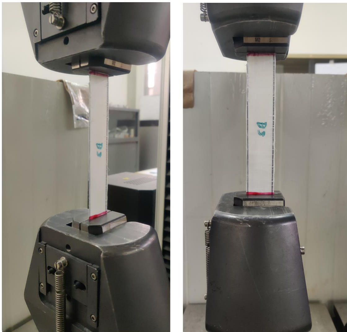
Εικόνα 119 : Δοκίμιο εφελκυσμού στις μηχανικές αρπάγεις της Instron® 4482 προ της δοκιμής.
