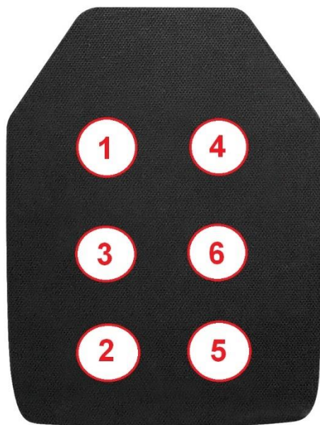
Εικόνα 106 : Μοτίβο αρίθμησης βολών του δοκιμίου 4.
