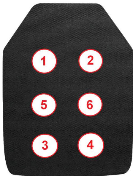
Εικόνα 100 : Μοτίβο αρίθμησης βολών των δοκιμών 3.A. και 3.B.
