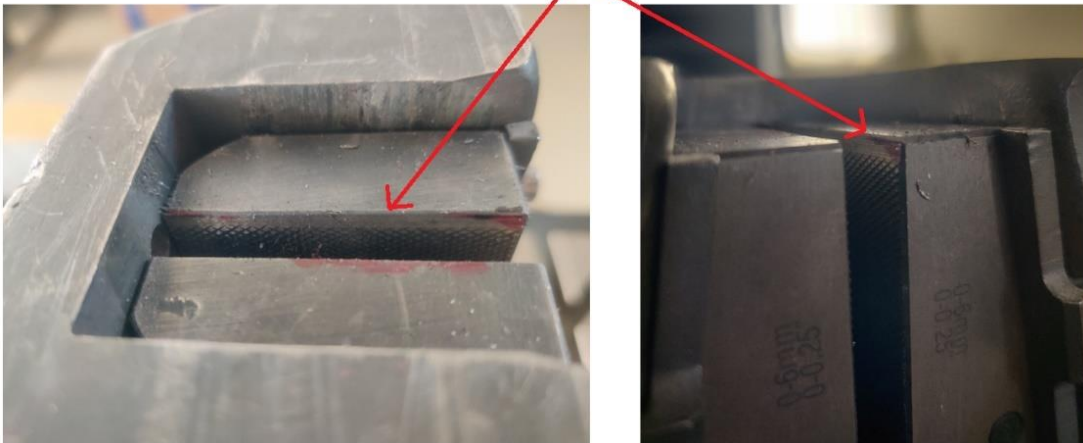
Εικόνα 120 : Λεία διαμόρφωση των αρπαγών της Instron® 4482.
