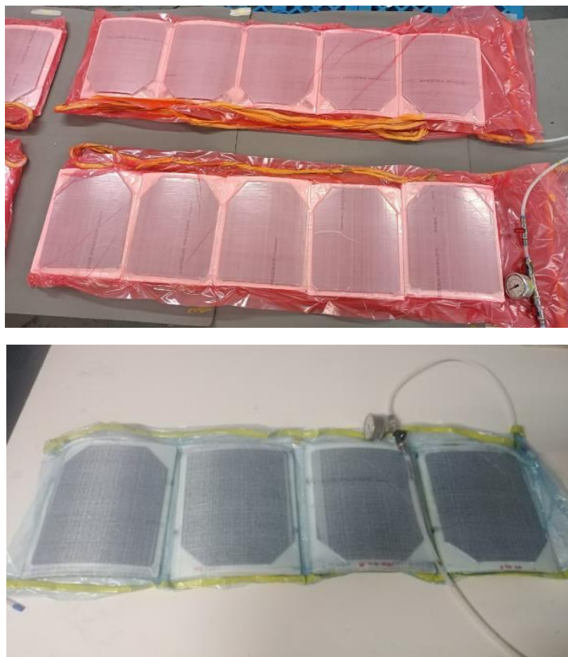
Εικόνα 73 : Συγκόλληση αντιθραυσματικής επίστρωσης, μονοκεραμικού ,πολύστρωτου συνθέτου UHMWPE και βαλλιστικού αφρού σε σακούλες κενού [Φωτογραφικό αρχείο Βενετσάνου Βασιλείου Οδυσσέα].
