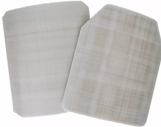
Εικόνα 55 : Μορφοποιημένα φύλλα UHMWPE σε πάνελ κατόπιν εξόδου από το καλούπι (πίσω) και μετά το πέρας της μορφοποίησης σε σχήμα SAPI (εμπρός) .
