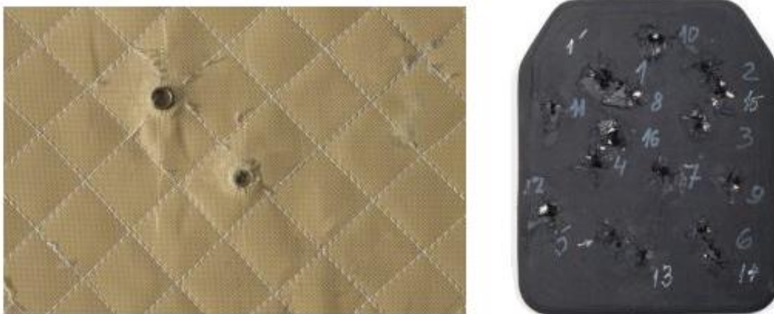
Εικόνα 30 : Kevlar Soft Armor (αριστερά) και Hard Body Armor (δεξιά) [59].
