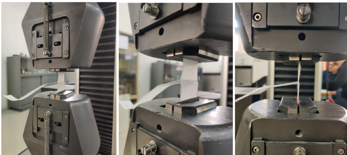
Εικόνα 136 : Δοκίμιο αποφλοίωσης στις μηχανικές αρπάγεις της Instron® 4482.
