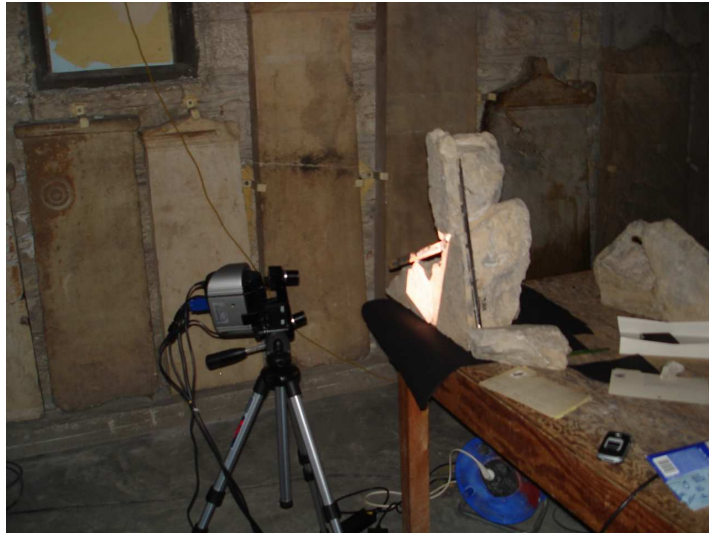
Εικόνα A-2 Διαδικασία λήψης τριδιάστατης απεικόνισης με χρήση 3D-Scanner
