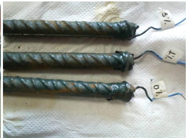
Σχήμα 3.24 (α) χάλυβας οπλισμού σκυροδέματος επικαλυμμένος με VCI 2 μετά από 24 ώρες ανοδικής φόρτισης σε κελί με υδατικό διάλυμα 3,5% κ.β NaCl, (β) χάλυβας οπλισμού σκυροδέματος επικαλυμμένος με VCI 2 μετά από 72 ώρες ανοδικής φόρτισης σε κελί με υδατικό διάλυμα 3,5% κ.β NaCl.
