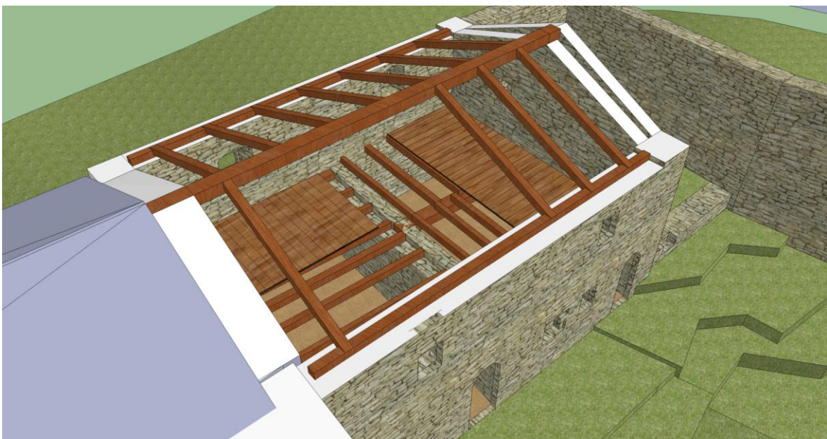
Εικόνα 114 - Λεπτομέρεια δομής στέγης – πατώματος. Τρισδιάστατη αναπαράσταση
