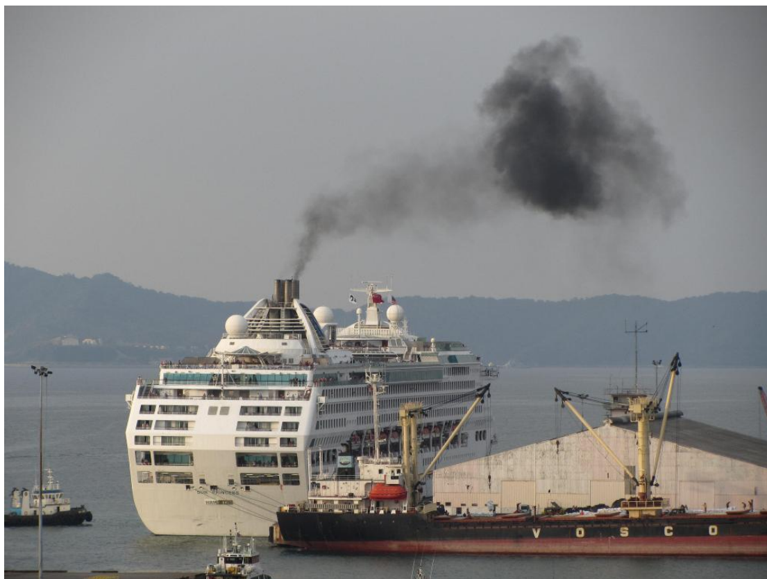
Εικόνα 4.1 Παράδειγμα ατμοσφαιρικής ρύπανσης από κρουαζιερόπλοιο εξαιτίας της λειτουργίας των βοηθητικών συστημάτων [4.1]
