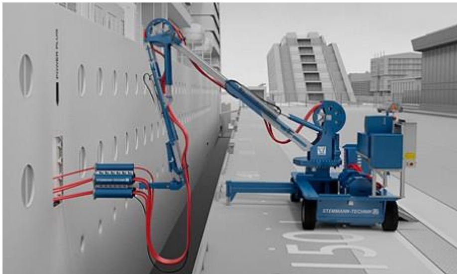
Εικόνα 6.2 Μηχανισμός ανύψωσης καλωδίου από τη στεριά, πηγή:Stemman-Technik
