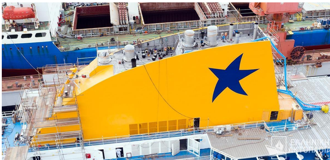
Εικόνα 3.7 Εγκατεστημένο scrubber στο Blue Star Myconos, πηγή: Attica Group
