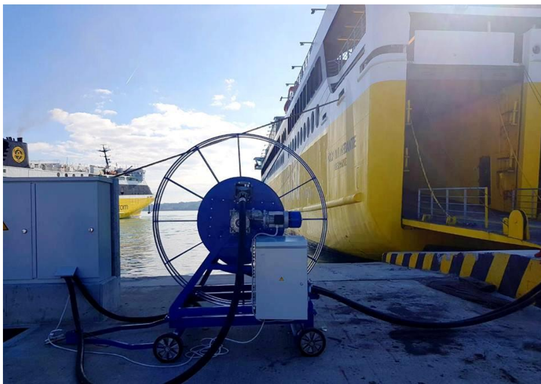
Εικόνα 4.4 Ηλεκτροδότηση του Fior di Levante με χρήση συστήματος Cold Ironing στο λιμάνι της Κυλλήνης, πηγή:metaforespess.gr
